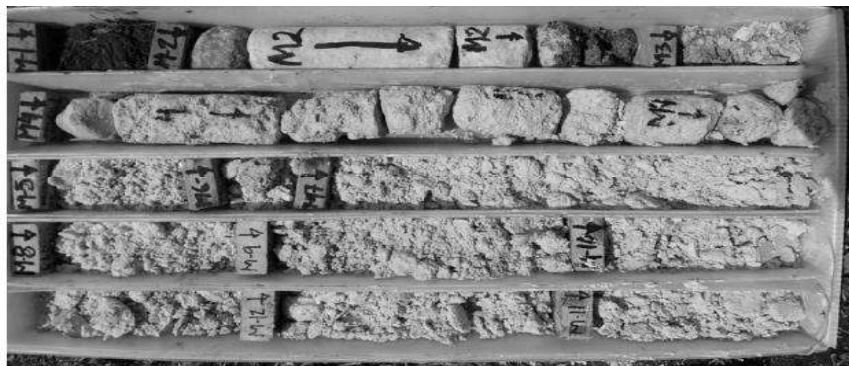
Ilustración 1.3 Ejemplo de testigo de una extracción continua, fotografía obtenida de los ensayos in situ facilitados por (GEEA Géologos, 2016).
