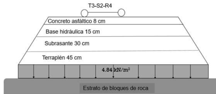
Ilustración 4.6 Estructura de pavimento flexible
