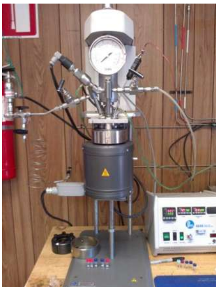
Figura 19 a/b. Reactor (a) y Cromatógrafo de gases utilizado(b).
