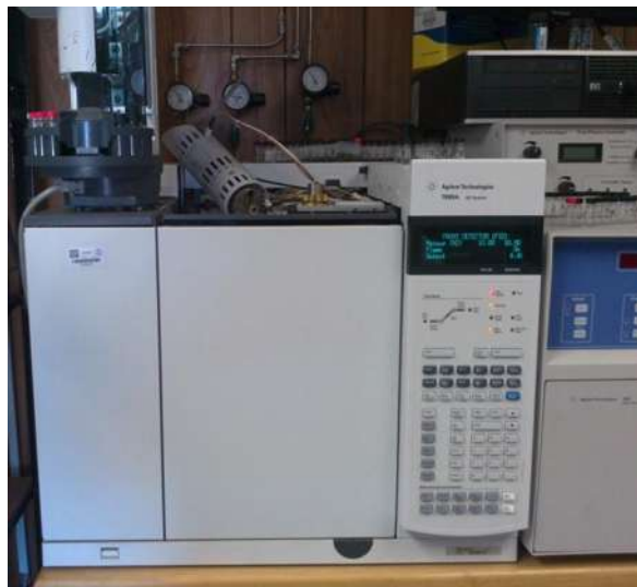
Figura 19 a/b. Reactor (a) y Cromatógrafo de gases utilizado(b).
