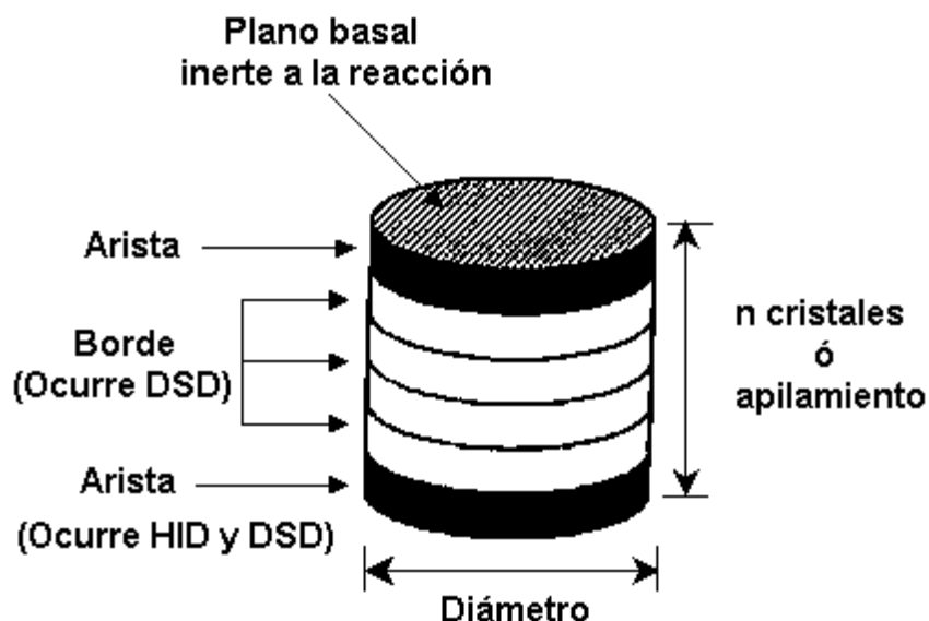
Figura 4.- Modelo “arista-borde” para sulfuros de metales de transición no promovidos (Daage & Chianelli, 1994).
