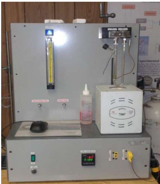
Figura 15. Equipo de sulfuración.
