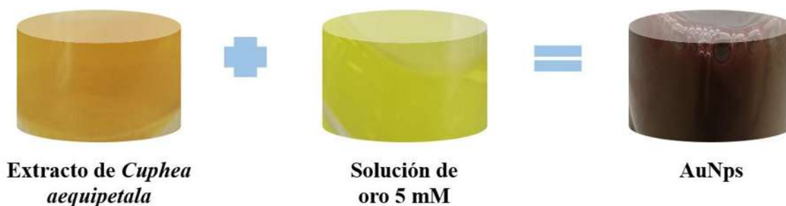
Figura 4. 2 Cambio de color en el proceso de síntesis de las AuNps utilizando una relación 1:1 y 6 mL de solución.
