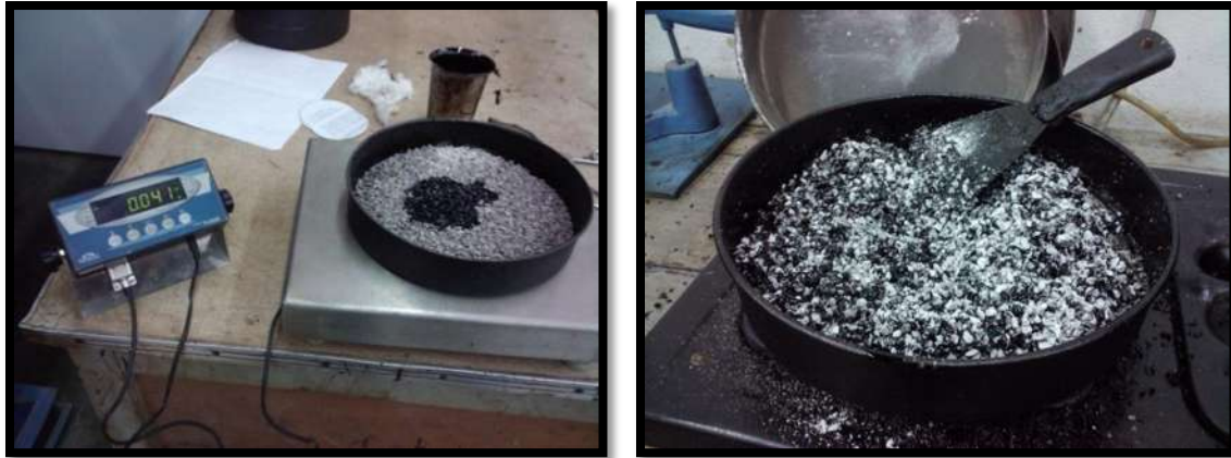
Fig. III.38 Adición del asfalto a los agregados pétreos y mezclado de los mismos.
