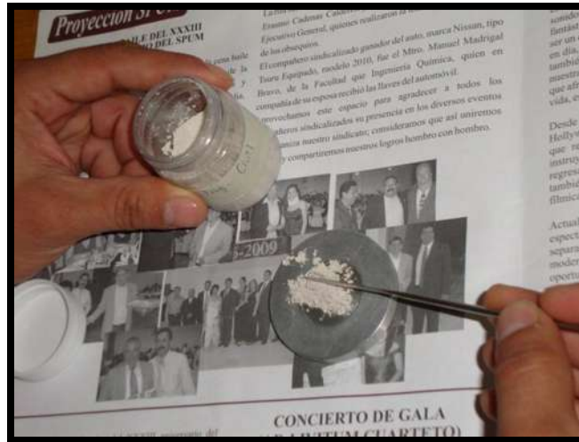
Fig. III.28 Colocación de la muestra en la pastilla metálica previo al análisis de difracción de rayos X.
