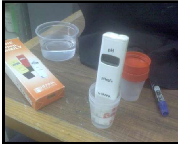
Fig. III.20 Calibración del pH-metro mediante la solución buffer previo al ensayo.
