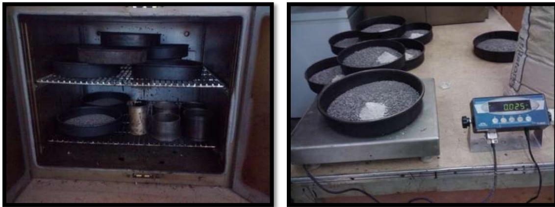
Fig. III.37 Precalentamiento de los agregados pétreos y los moldes Marshall.
