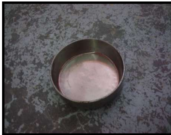
Fig. III.10 Capa de aceite para impedir adherencia entre la muestra y las paredes de la capsula.
