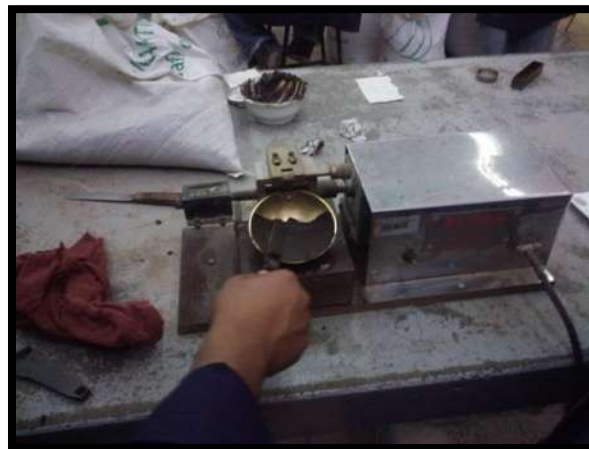
Fig. III.4 Colocación del material en la copa de casa grande.
