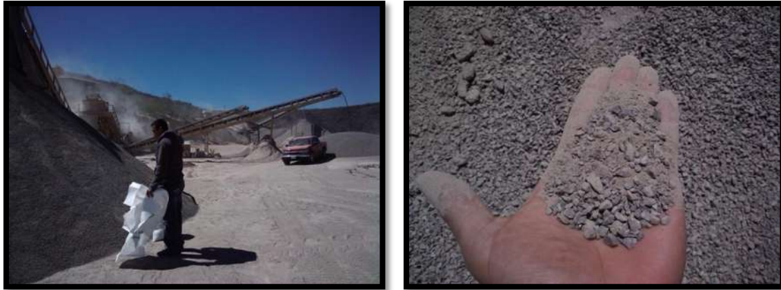
Fig. III.33 Muestreo en banco de materiales para la obtención de la fracción pétreo.
