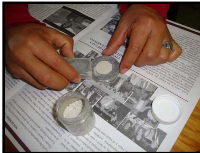
Fig. III.29 Enrasado y nivelación de la superficie de la muestra para el ensayo.
