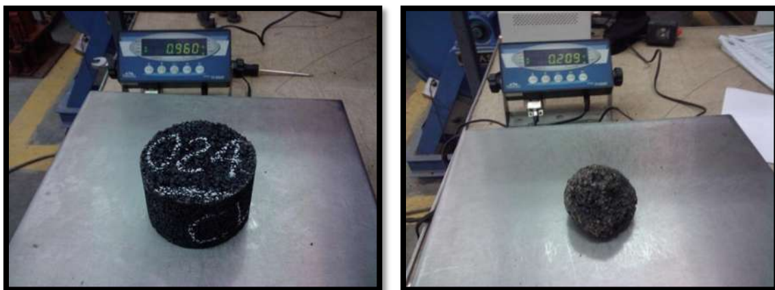
Fig. III.42 Pesado de la probeta tipo antes y después del ensayo en la máquina de los ángeles.
