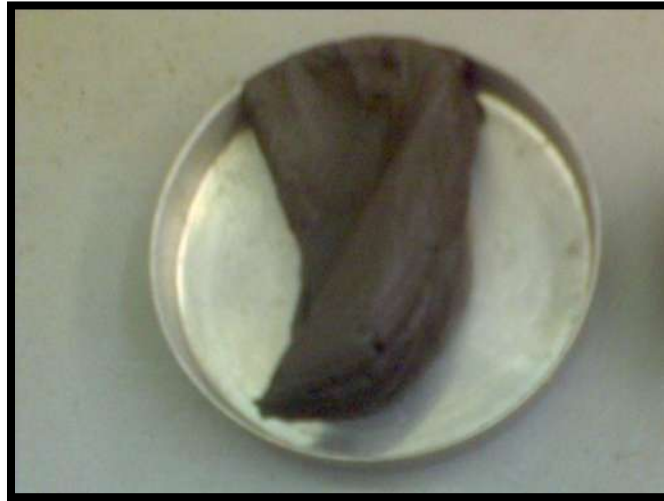
Fig. III.7 Muestra para el cálculo de contenido de humedad del ensayo de límite líquido.
