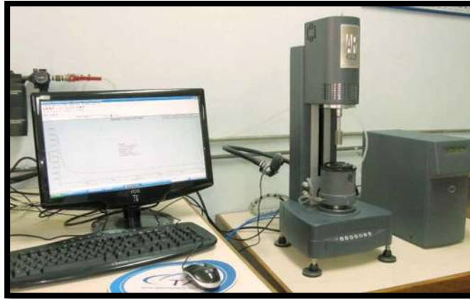
Fig. III.46 Reómetro de corte dinámico ( DSR ) empleado para la caracterización del mástico.
