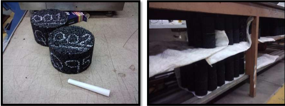
Fig. III.40 Identificación y almacenamiento de las probetas tipo Marshall fabricadas.
