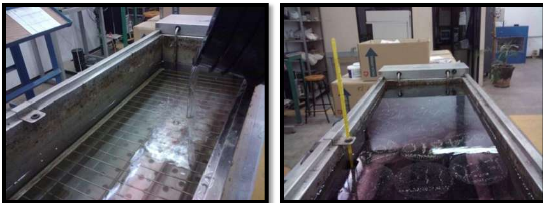
Fig. III.43 Probetas sometidas a baño María a 60 \pm 2^{\circ}\text{C} durante 24 horas como parte del acondicionamiento.
