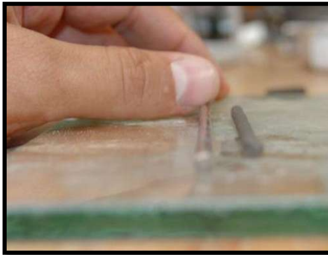
Fig. III.8 Comparación del diámetro del rollo de material obtenido con el alambre de diámetro patrón.
