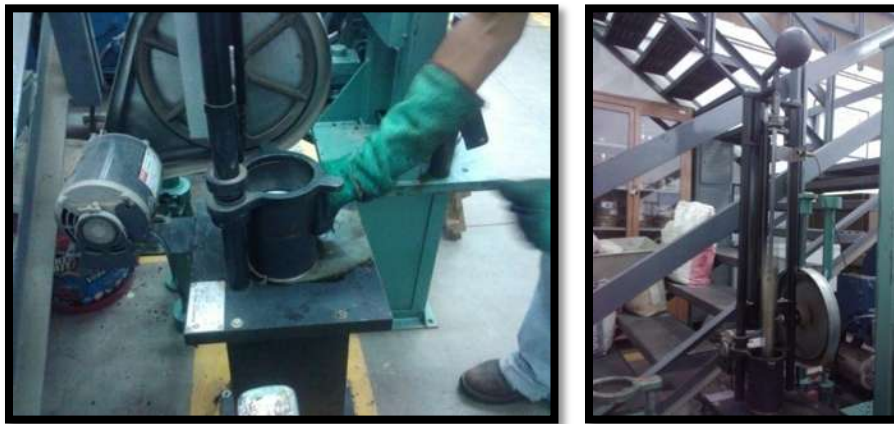
Fig. III.39 Compactación de la mezcla de asfalto, filler y agregados potros mediante el compactador Marshall.
