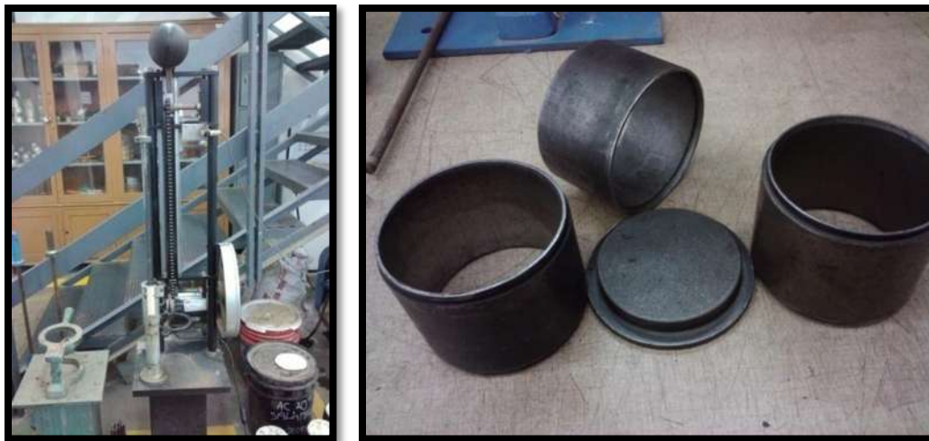
Fig. III.36 Compactador y moldes Marshall empleados para la fabricación de las probetas de ensayo.
