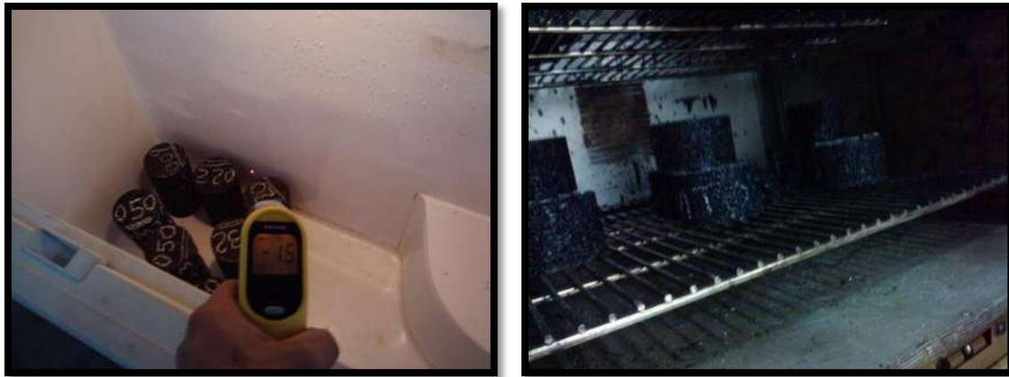
Fig. III.41 Exposición de las probetas elaboradas con cada tipo de filler a las diferentes temperaturas de ensayo.
