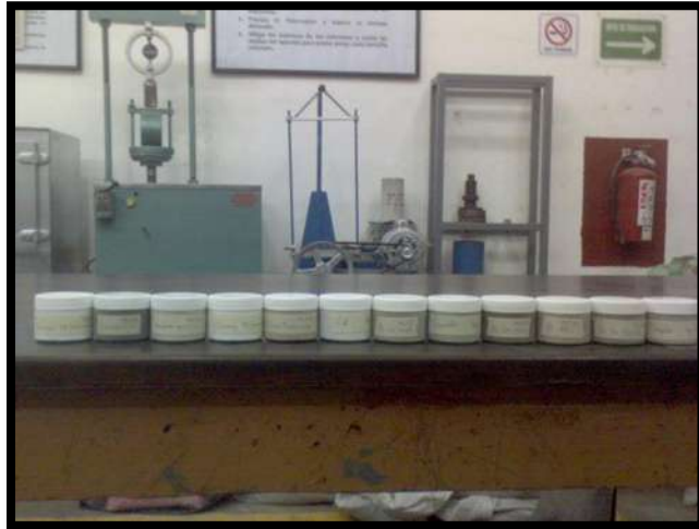
Fig. III.21 Muestras representativas de cada material para realizar el ensayo de granulometría fina.
