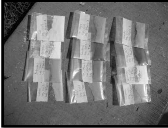
Fig. III.25 Muestras representativas de cada filler para el ensayo de microscopia electrónica de barrido.
