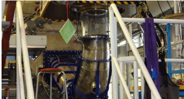
Figura 4. Equipo de prueba turbina / bomba-turbina Francis. Vista completa de la carcasa en espiral, el cono del tubo de aspiración, el codo y la descarga de la turbina conectada al tanque aguas abajo. Las mediciones de presión y velocidad (LDV y PIV) pueden realizarse en la sección transparente del cono del tubo de aspiración [12].
