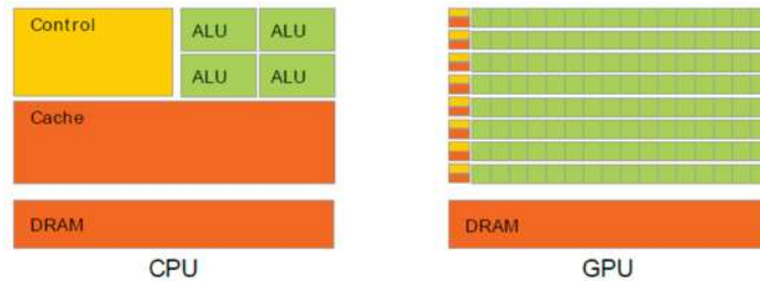
Figura 16. Comparación de asignación de transistores para procesamiento de datos en CPU y GPU [36].
