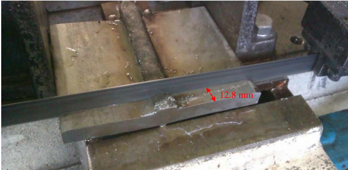
Figura III. 6.- Las placas soldadas fueron seccionadas para obtener las probetas, utilizando una cortadora sierra sin fin marca ARFA modelo RF 812 N.
