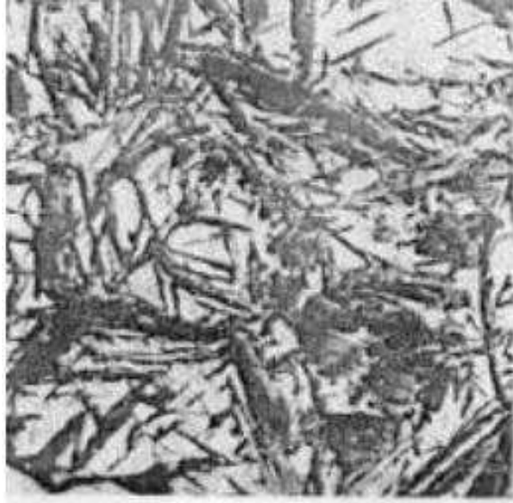
Figura II. 5.- Microestructura típica de un acero inoxidable martensítico [12].
