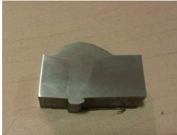
Figura III. 8.- Cordón de soldadura revelado con Villela.
