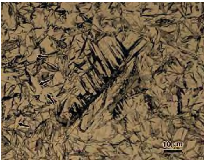
Figura 2.4 Microestructura de un acero inoxidable martensítico 410 en su condición de temple y revenido, mostrando una microestructura de ferrita + carburos (1).
