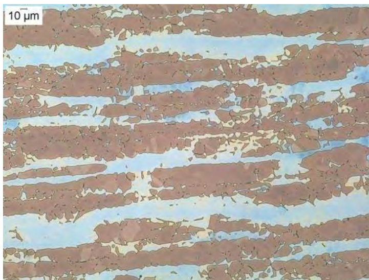
Figura 4.1 Microestructura bifásica de ferrita+austenita del AISD SAF 2507 en su condición de recibido.
