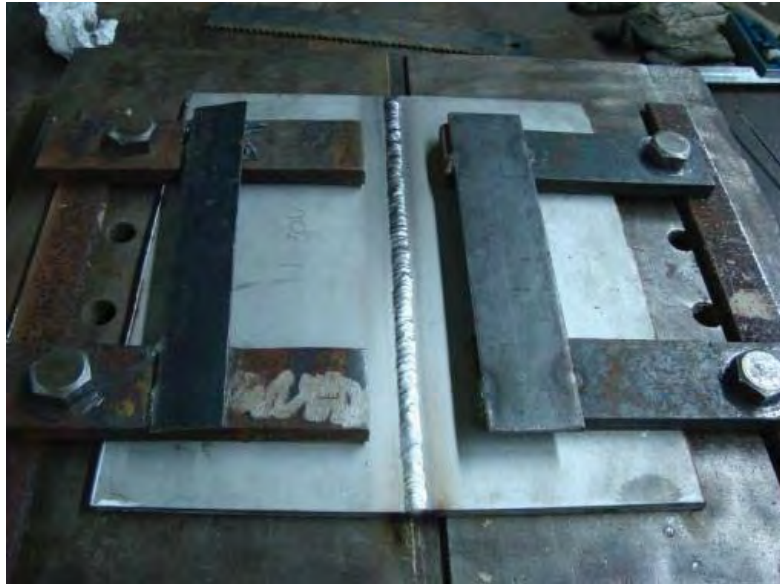
Figura 3.5. Placas de acero inoxidable superdúplex sujetadas por una placa disipadora de calor.
