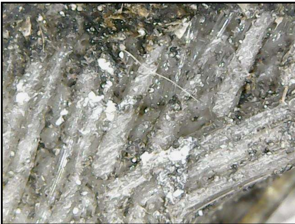
Figura 30 Micrografía de la formación de biopelícula en las estructuras impresas 3D pretratadas con mucílago e inóculo sin alimentación a los 16 días.
