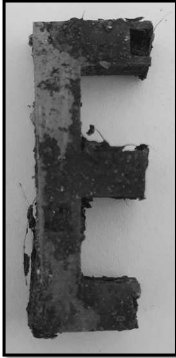
Figura 32 Ilustración de la formación de biopelícula en las estructuras impresas 3D sin pretratamiento y alimentando el inóculo a los 16 días.
