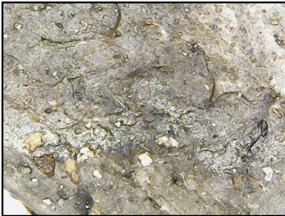
Figura 36 Micrografía de la formación de biopelícula en las estructuras impresas 3D sin pretratamiento e inóculo sin alimentación a los 16 días.
