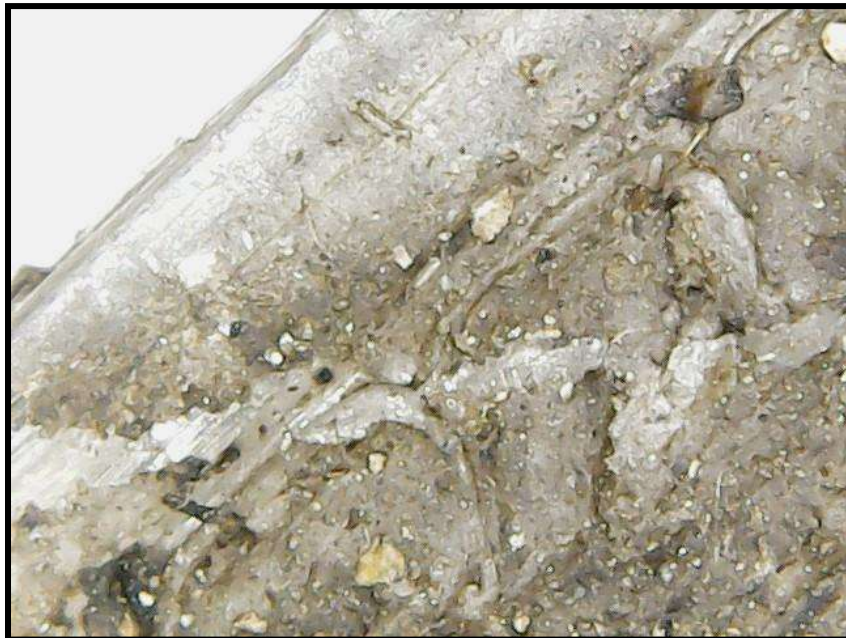
Figura 33 Micrografía de la formación de biopelícula en las estructuras impresas 3D sin pretratamiento y alimentando el inóculo a los 16 días.
