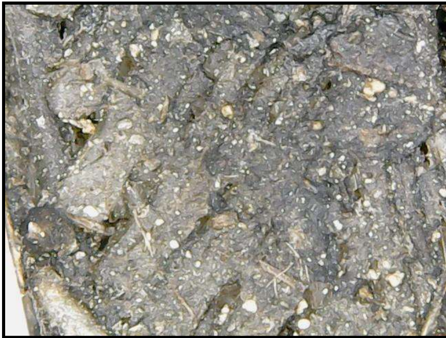
Figura 27 Micrografía de la formación de biopelícula en las estructuras impresas 3D pretratadas con mucílago e inóculo alimentado a los 16 días.
