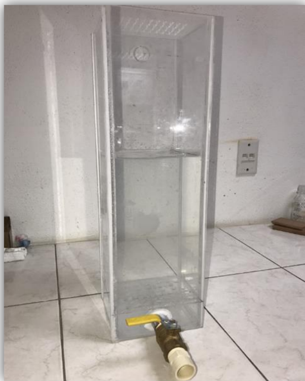
Figura 13. Reactor de acrílico de base cuadrada.
