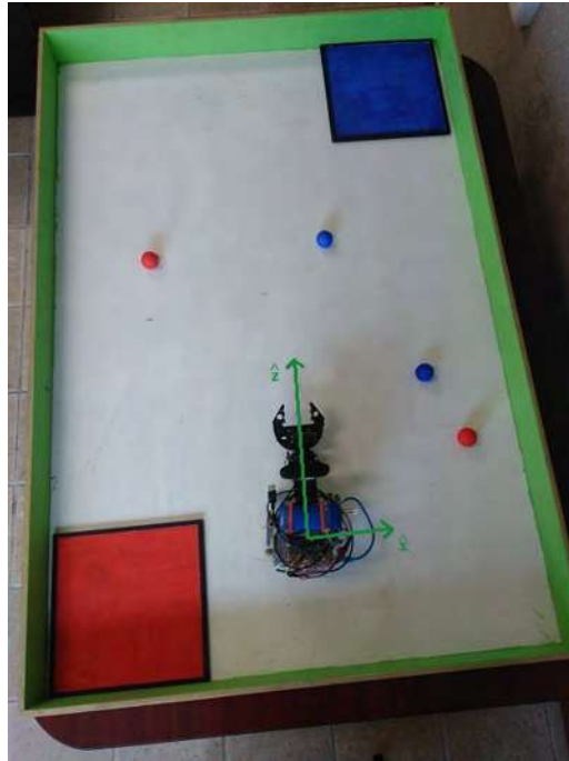
Figura 4.6: Coordenadas (\hat{x}, \hat{z}) del ambiente del robot.
