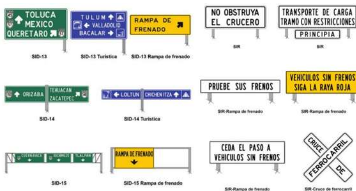
Figura 29. Señales informativas. Tomada de manual de señalización vial y dispositivos de seguridad 2014 (pp. 139,141)
