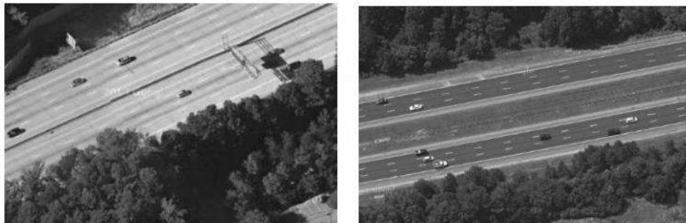
Figura 1. Segmento básico de autopista en una zona urbana (izquierda) y segmento básico de autopista en una zona rural (derecha). Tomada de HCM, 2016
