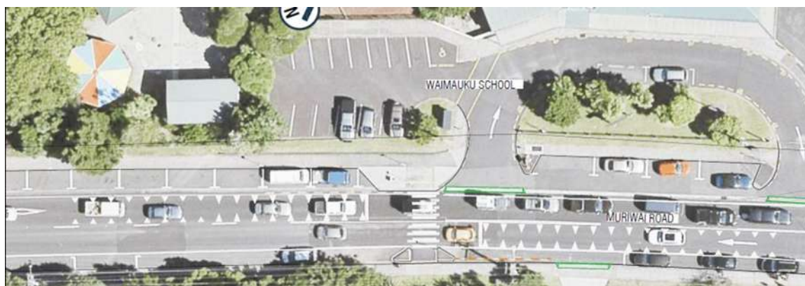
Figura 39. Ejemplo de Marca de dientes de dragón en zona escolar (tipo A), Murawai Road, by Waimauku School. Tomada de https://at.govt.nz/projects-roadworks/dragons-teeth-road-markings-trial/
