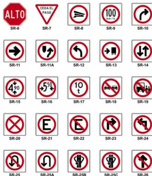
Figura 28. Señales restrictivas. Tomada de manual de señalización vial y dispositivos de seguridad 2014 (p. 67)
