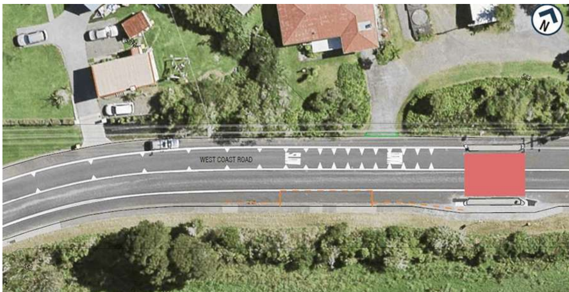
Figura 40. Marca de dientes de dragón en vía rápida (tipo B). West coast Road, By Oratia District School. Tomada de https://at.govt.nz/projects-roadworks/dragons-teeth-road-markings-trial/
