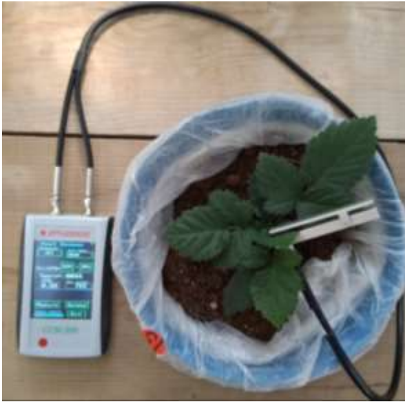
Figura 40. Medición de concentración de clorofila en plantas de Zarzamora ( Rubus fruticosus var. Tupi), con el uso del equipo Opti-Science.
