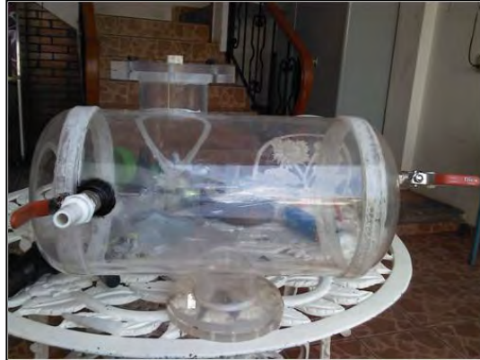
Figura 4.8 Tanque sellado y con válvulas instaladas.
