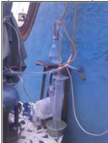
Figura 4.13 Sistema para lavado y medición del volumen y temperatura del biogás producido.
