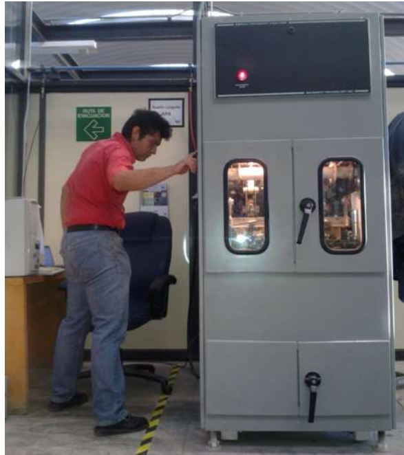
Fig. 29 Analizador de Pavimentos Flexibles
