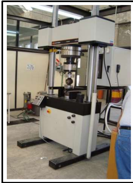
Figura 10. Ensayo de Tensión Indirecta.
