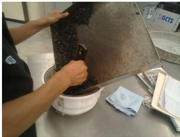
Fig. 20 Colocación de material para Gmm
