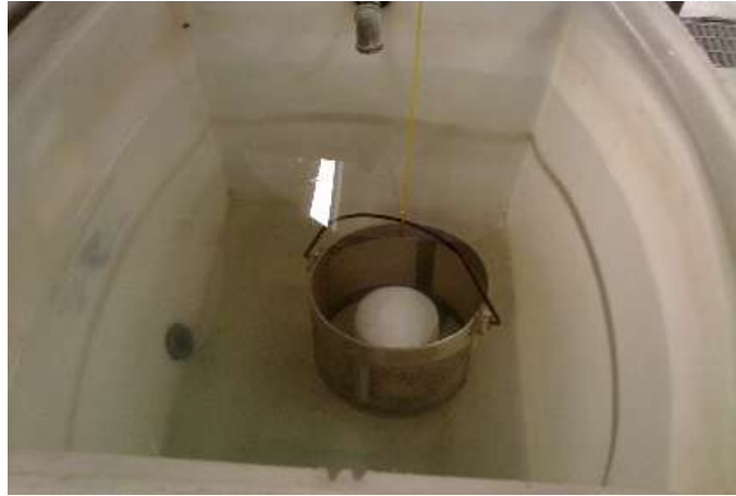
Fig. 28 Pobeta con parafina en baño de agua
