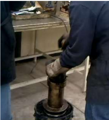
Fig. 25 Compactación de Probetas
