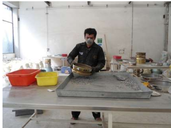
Fig. 15 Proceso de Cribado
