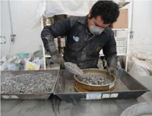
Fig. 16 Cribado de material grueso
