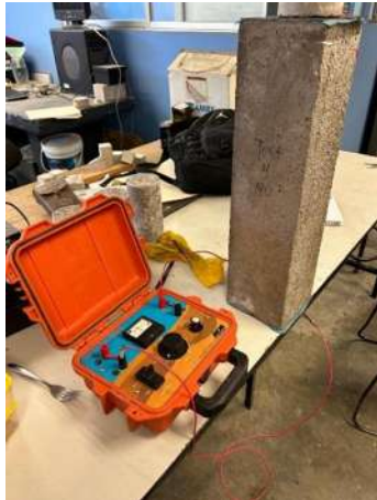
Ilustración 35 Equipo de resistividad eléctrica. Fuente: Elaboración propia.
