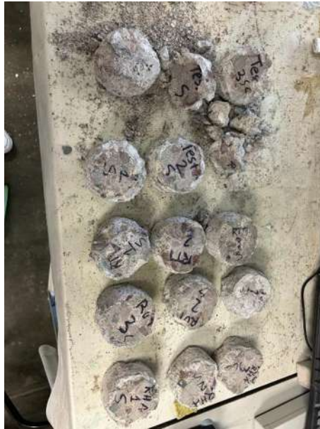
Ilustración 64 rodajas de cilindros de 10 cm de diámetro x 5 cm de altura en el último ciclo de ataque por sulfatos. Fuente: Elaboración propia.
