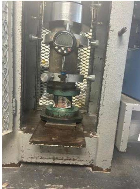
Ilustración 43 prueba de módulo de elasticidad estática en cilindros de 10 cm de diámetro y 20 cm de longitud. Fuente: Elaboración propia.
