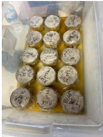
Ilustración 46 Rodajas puestas en el recipiente con agua. Fuente: Elaboración propia.
