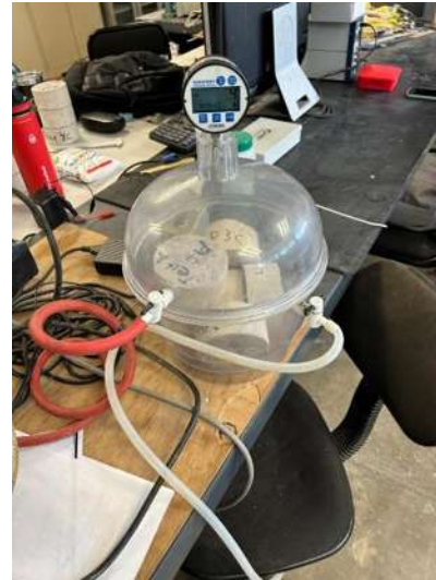
Ilustración 55 Dejando en vacío por 3 horas los especímenes. Fuente: Elaboración propia.
