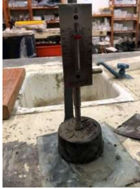
Ilustración 1. Consistencia normal del cemento. Fuente: Elaboración propia.
