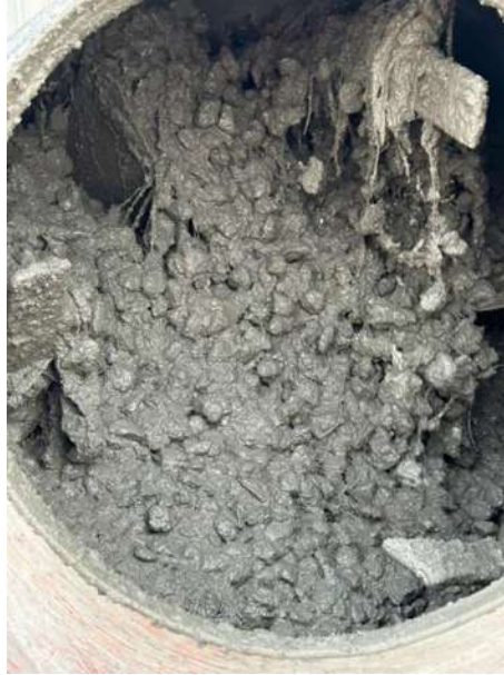
Ilustración 61. Fibras enredadas en las aspas de la revolvedora al momento de la elaboración de la mezcla. Fuente: elaboración propia.
