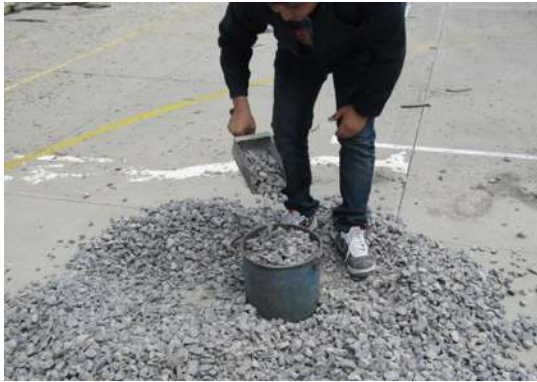
Ilustración 21 Llenado de la MVSS. Fuente: Elaboración propia.
