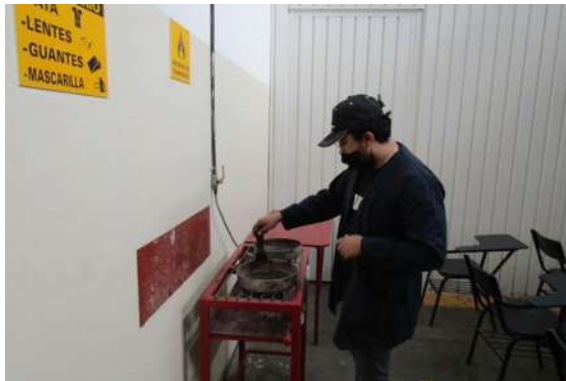
Ilustración 11 Humedad de Absorción de la arena. Fuente: Elaboración propia.
