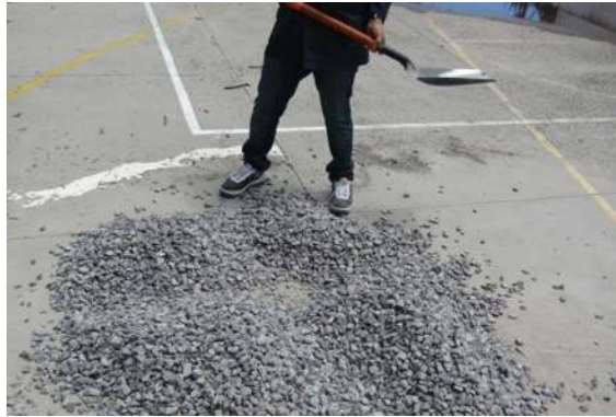
Ilustración 20 Cuarteo de grava. Fuente: Elaboración propia.
