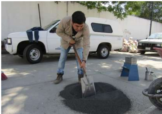
Ilustración 5 Cuarteo de arena. Fuente: Elaboración propia.
