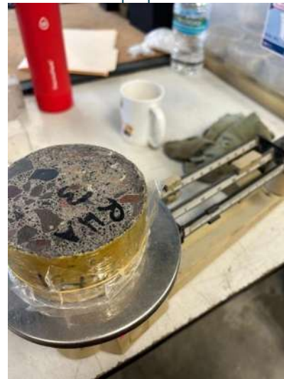
Ilustración 47 Obtención de masa de la muestra Fuente: Elaboración propia.
