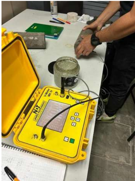
Ilustración 37 Equipo de VPU. Fuente: Elaboración propia.
