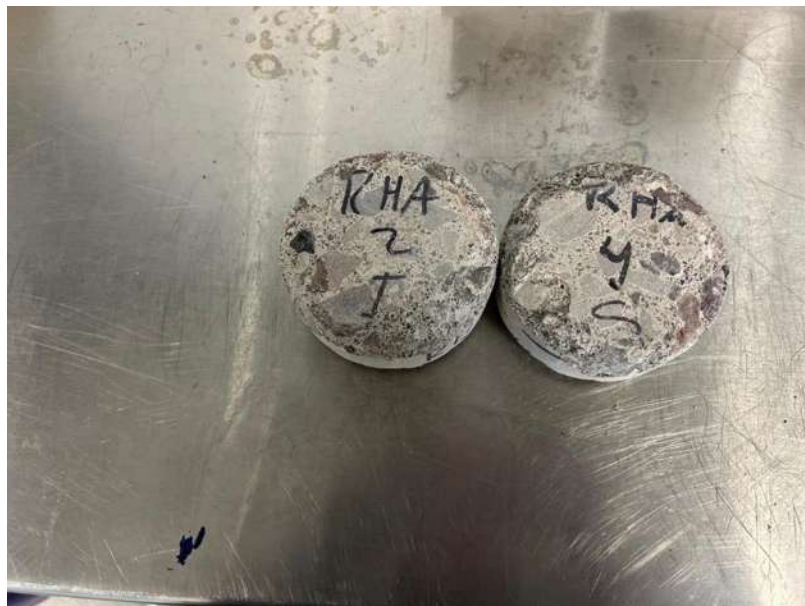
Ilustración 66 Mezcla RHA sometida a la prueba de cántabro. Fuente: Elaboración propia
