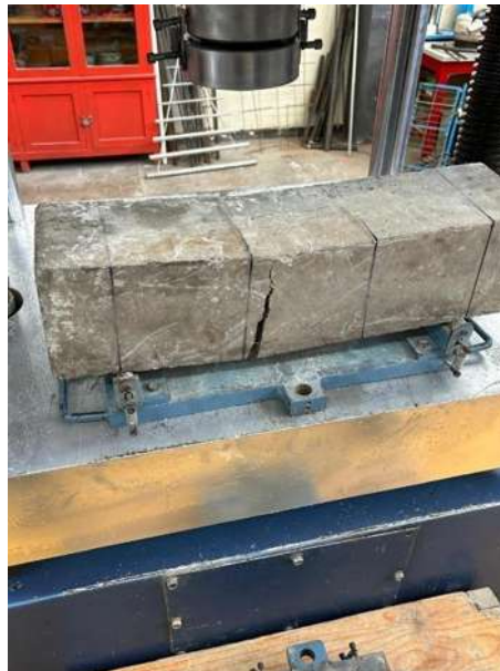
Ilustración 63 Falla de viga sometida a flexión con adición de fibras textiles. Fuente: elaboración propia.
