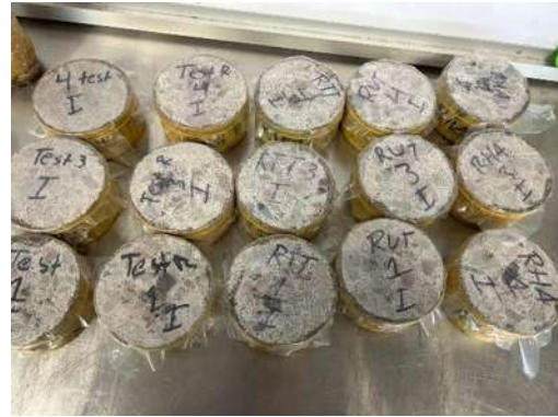
Ilustración 45 Rodajas de concreto con bolsa y selladas por los lados. Fuente: Elaboración propia.
