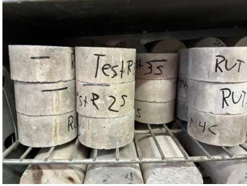
Ilustración 44 Muestras de concreto en el horno. Fuente: Elaboración propia.
