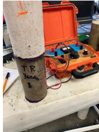
Ilustración 36 Resistividad eléctrica del espécimen. Fuente: Elaboración propia.
