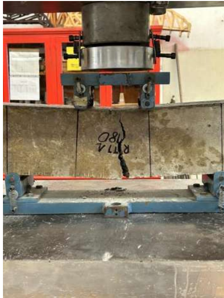
Ilustración 42 Módulo de ruptura de la viga de 15 x 15 x 60 cm. Fuente: Elaboración propia
