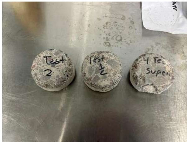
Ilustración 65 Mezcla Testigo sometida a la prueba de cántabro. Fuente: Elaboración propia
