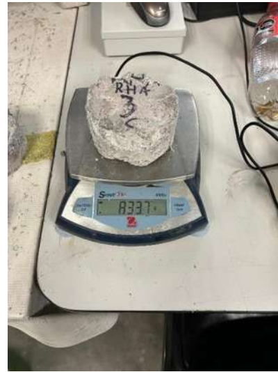
Ilustración 49 Obtención de masa de las rodajas. Fuente: Elaboración propia.
