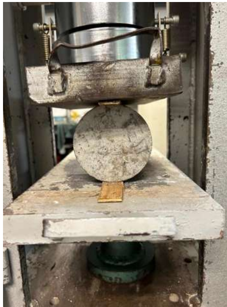
Ilustración 41 prueba de resistencia a la tensión por compresión diametral en cilindros de 10 cm de diámetro y 20 cm de longitud. Fuente: Elaboración propia.
