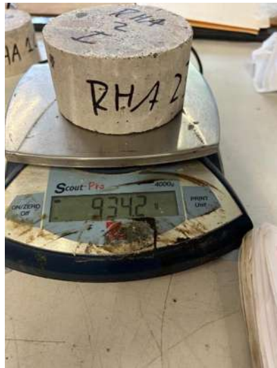
Ilustración 52 Obtención de masa de las muestras antes de ser introducida a la máquina de desgaste de los ángeles. Fuente: Elaboración propia.
