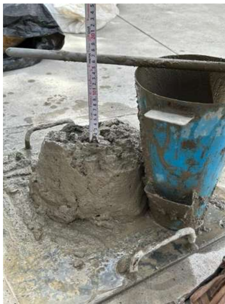
Ilustración 32 Revenimiento de concreto fresco. Fuente: Elaboración propia.
