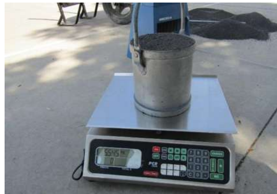
Ilustración 8 Masa de la arena con el recipiente. Fuente: elaboración propia.
