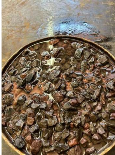
Ilustración 25 Saturación de la grava triturada. Fuente: Elaboración propia.
