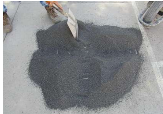
Ilustración 6 Cuarteo de arena. Fuente: Elaboración propia.
