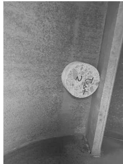
Ilustración 53 Muestra introducida a la máquina de desgaste de los ángeles. Fuente: Elaboración propia.
