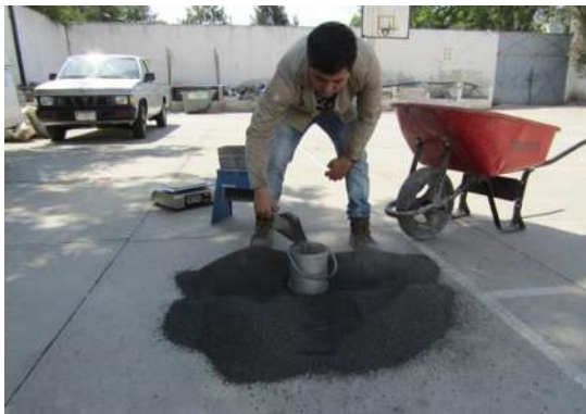
Ilustración 7 MVSS de la arena. Fuente: Elaboración propia.
