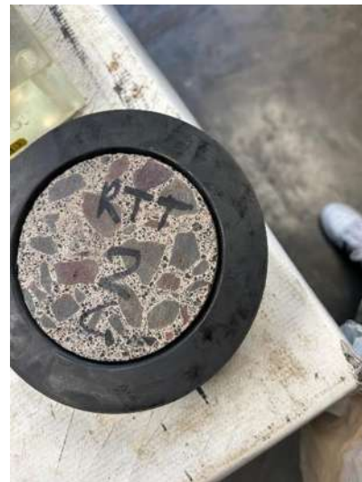
Ilustración 57 Colocación de empaques al espécimen. Fuente: Elaboración propia.
