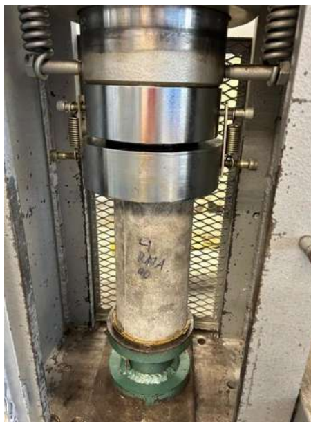
Ilustración 40 prueba de resistencia a la compresión simple en cilindros de 10 cm de diámetro y 20 cm de longitud. Fuente: Elaboración propia.
