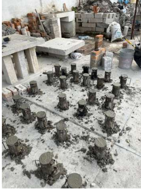
Ilustración 33 Elaboración de cilindros 15 x 30. Fuente: Elaboración propia.
