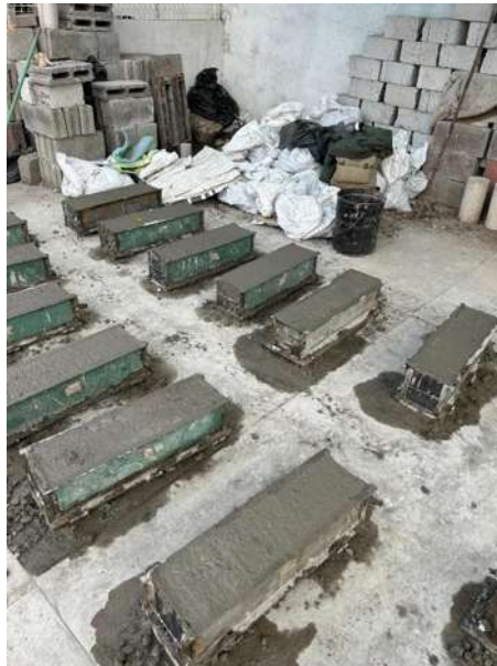
Ilustración 34 Elaboración de vigas de dimensiones 15 cm x 15 cm y longitud de 60 cm. Fuente: Elaboración propia.
