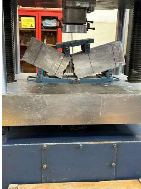
Ilustración 62 Falla de viga sometida a flexión sin adición de fibras textiles. Fuente: elaboración propia.
