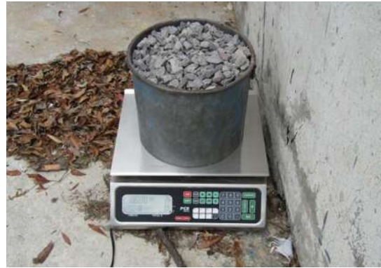
Ilustración 22 masa de la MVSS. Fuente: Elaboración propia.
