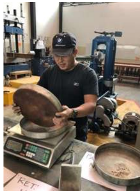
Ilustración 27 Granulometría de la grava triturada. Fuente: Elaboración propia.
