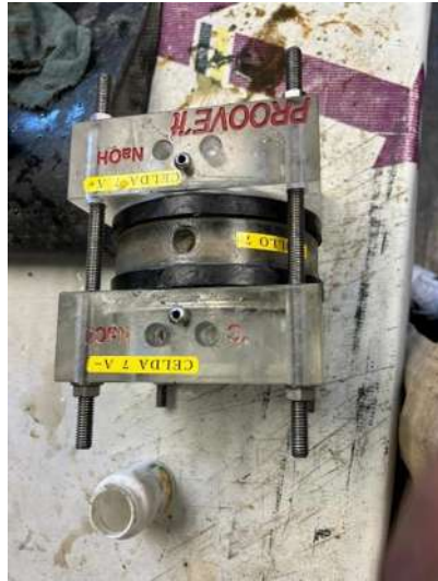
Ilustración 58 Colocación de las celdas al equipo. Fuente: Elaboración propia.
