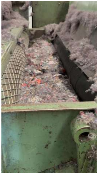
Ilustración 29 Procesos de trituración de los residuos textiles. Fuente: Elaboración propia.
