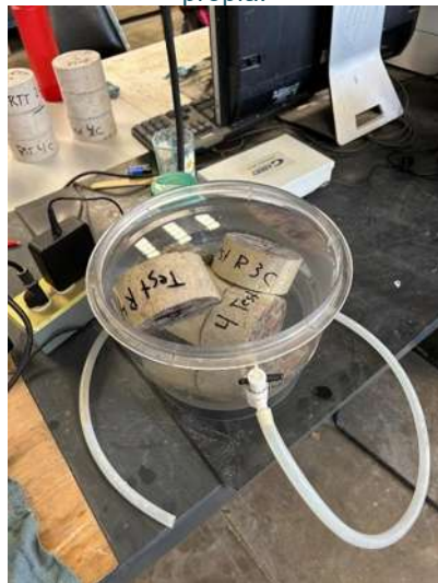
Ilustración 56 Especímenes una vez pasado el tiempo de saturación. Fuente: Elaboración propia.
