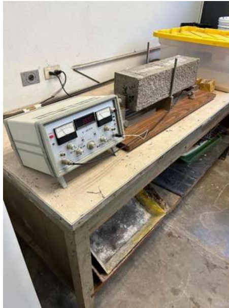
Ilustración 39 Lectura del equipo de e-meter, para obtener la frecuencia de resonancia del espécimen de concreto. Fuente: Elaboración propia.
