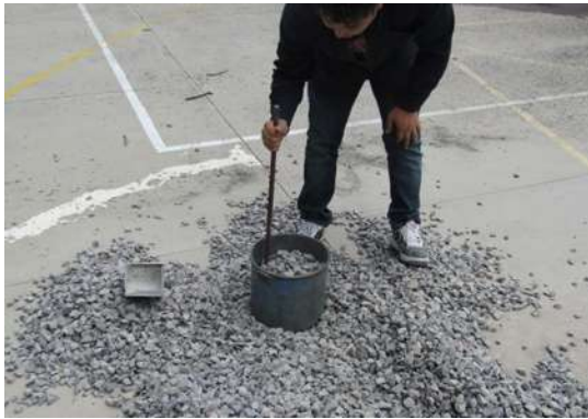
Ilustración 23 Compactación con la varilla de la grava. Fuente: Elaboración propia.
