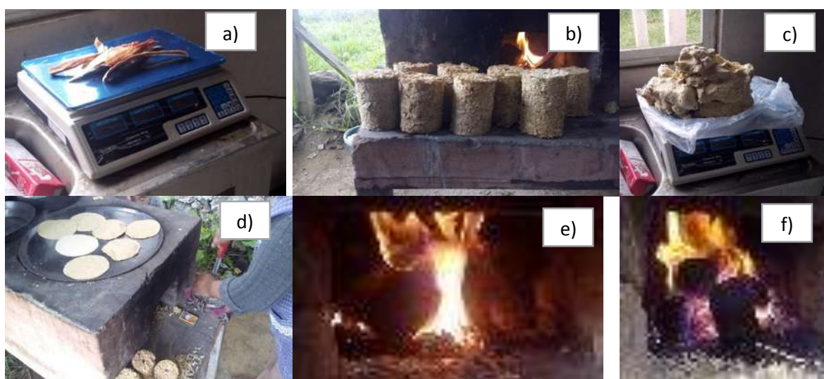
Figura 4.46. a) Peso del iniciador, b) Briquetas (combustible), c) Masa para las tortillas, d) utilización de la patsari y elaboración de las tortillas, e) Briquetas combustionadas en la Patsari, f) Calcinación de las briquetas.
