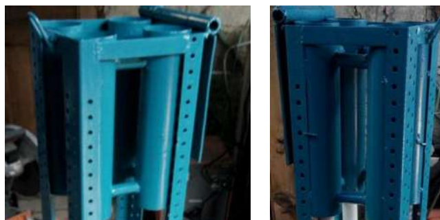
Figura 4.20. Construcción de los moldes y añadidos a la base
