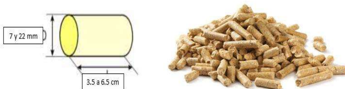
Figura 2.14. Pellets y dimensionamiento promedio
