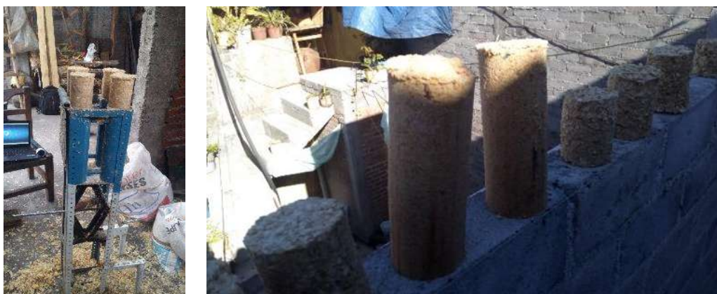
Figura 4.40. Izquierda briquetas obtenidas del molde, derecha briquetas expuestas al sol para su secado.
