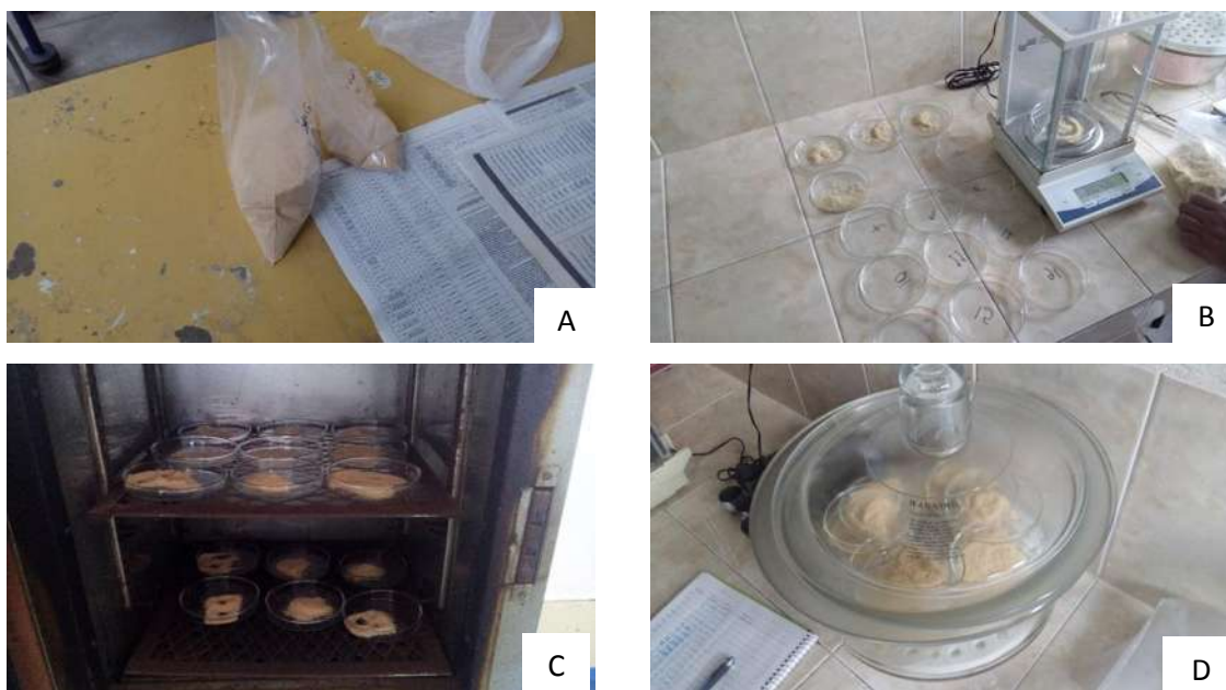
Figuras 4.27. A) Muestras a analizar B) Peso de un gramo de la muestra y colarlo en la caja de Petri C) Colocación de las muestras en la estufa de secado hasta peso constante D) Muestras colocadas en el desecador.
