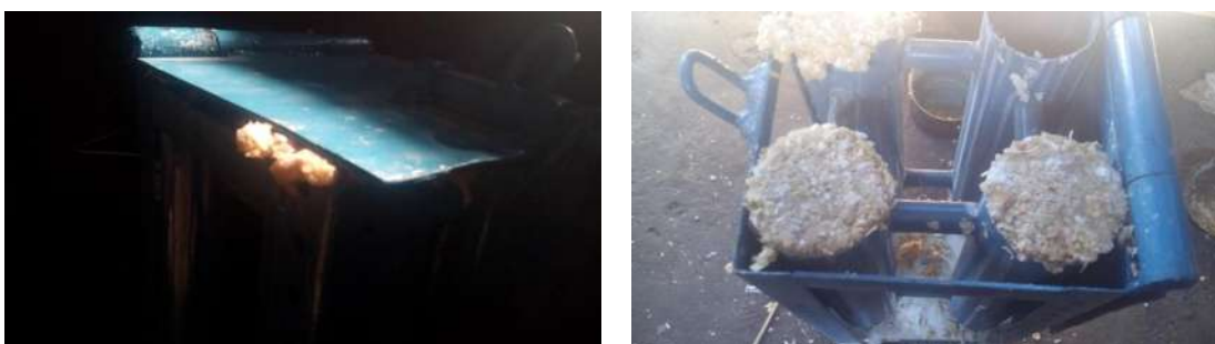
Figura 4.39. Compresión de la mezcla lo más fuerte posible
