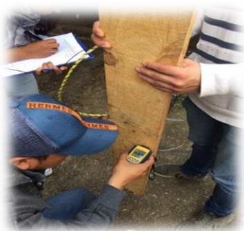
Figura 4.2. Medición de humedad
