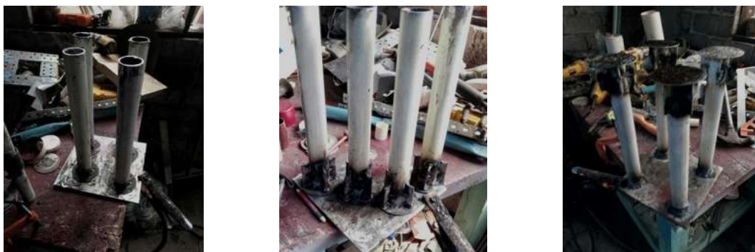
Figura 4.22. Proceso de construcción del eje la parte vital de la máquina briqueteadora
