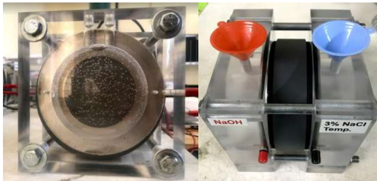
Ilustración 44. A la izquierda: Tornillos para sujetar las celdas y mantener en confinamiento las pastillas, A la derecha: Embudos por los cuales se vertió cada una de las soluciones. (García Chávez, 2019)
