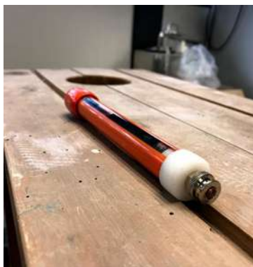
Ilustración 26. electrodo RE-7 marca: McMILLER para determinación de Potencial ( E_{\text{corr}} ). (García Chávez, 2019)
