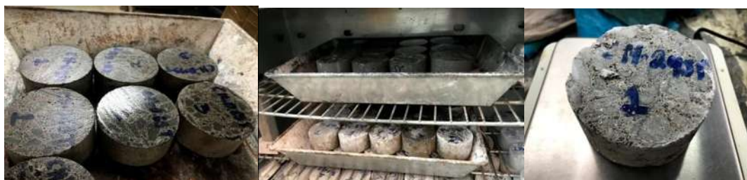
Ilustración 34. Arriba izquierda: Colocación de las rodajas en charolas de acero inoxidable. Arriba derecha: Colocación de las charolas con los especímenes de estudio en el horno de secado hasta alcanzar su masa constante, Abajo: Monitoreo de Ws de cada uno de los especímenes hasta alcanzar masa constante. (García Chávez, 2019)
