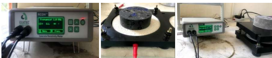
Ilustración 48. Resistómetro (RCON™) para medir la R_e de los especímenes de estudio. (García Chávez, 2019)
