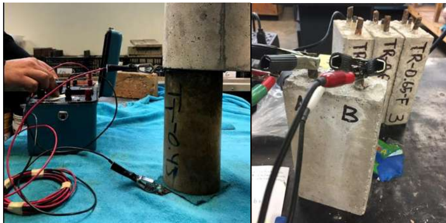
Ilustración 18. A la izquierda: medición de la R_e para especímenes del lote (a). A la derecha: medición de la intensidad de corriente y voltaje para determinar R_e en los especímenes del lote (b). (García Chávez, 2019)
