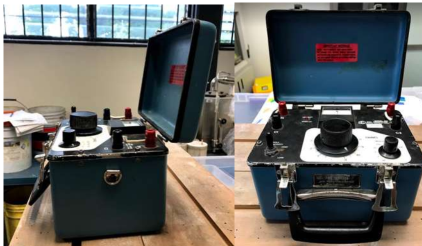
Ilustración 17. Resistómetro utilizado para determinar la resistividad eléctrica. (García Chávez, 2019)
