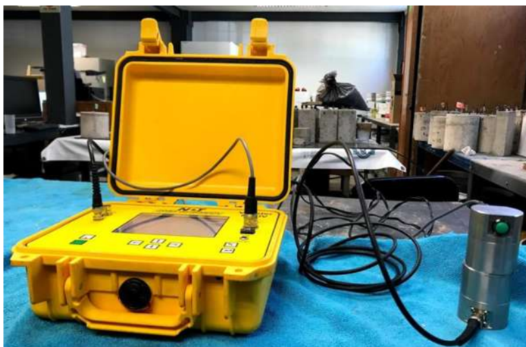
Ilustración 19. Sistema digital para ensayos ultrasónicos, para determinar la VPU. (García Chávez, 2019)
