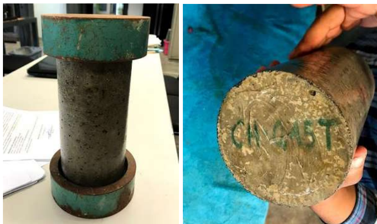
Ilustración 11. Partes y composición de un espécimen cilíndrico de 10cmx20cm. Elaborado con agregado triturado con a/c = 0.45 . (García Chávez, 2019)
