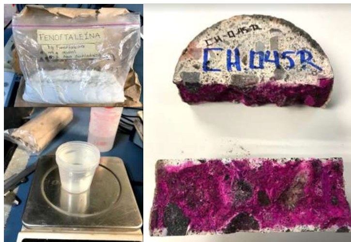
Ilustración 39. Preparación y colocación de la solución de Fenolftaleína a los especímenes de estudio. (García Chávez, 2019)
