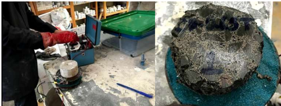
Ilustración 33. A la izquierda: Medición de la Re de los especímenes de estudio. A la derecha: Evaluación física del espécimen de estudio. (García Chávez, 2019)
