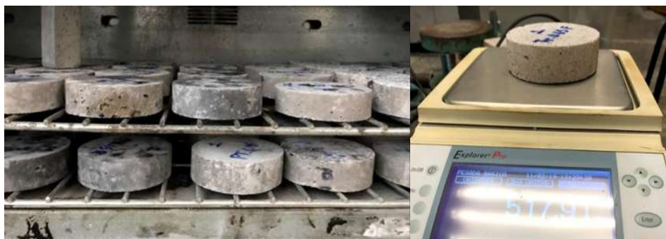
Ilustración 29. A la izquierda: Especímenes secando en horno a temperatura constante de 50^{\circ}\text{C} , A la derecha: Monitoreo de pesos hasta obtener masa constante. (García Chávez, 2019)
