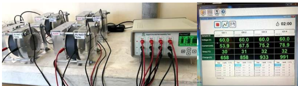
Ilustración 46. A la izquierda: 4 pastillas con el centro de control, A la derecha: programa del ordenador para llevar a cabo las lecturas. (García Chávez, 2019)
