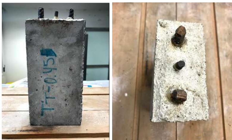
Ilustración 12. Partes y composición de un espécimen rectangular de 20cmx10cmx5cm. Elaborado con agregado triturado con a/c = 0.45 . (García Chávez, 2019)
