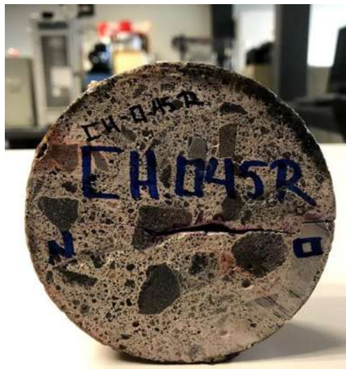
Ilustración 38. Rodaja libre de polvo y lista para analizar. (García Chávez, 2019)
