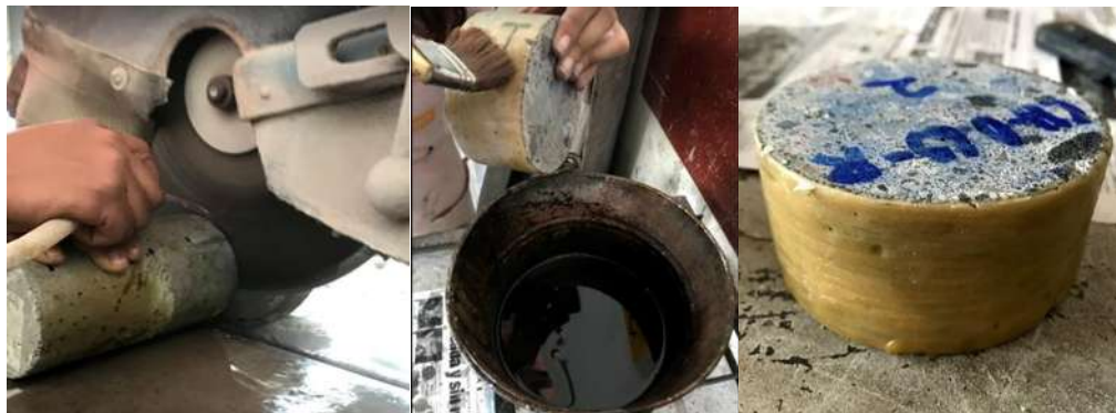
Ilustración 35. A la izquierda: cortadora de roca para extracción de rodajas. Al centro: cubierta de parafina en muestras. A la derecha: rodaja cubierta de parafina . (García Chávez, 2019)
