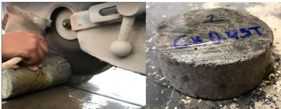
Ilustración 42. A la izquierda: Cortadora de roca, A la derecha: Rodajas de 10cm x 5cm. (García Chávez, 2019)
