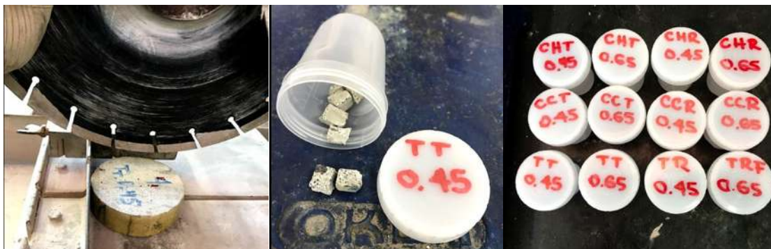
Ilustración 13. A la izquierda: Corte de especímenes de concreto para extracción de esquirlas. Al centro: esquirlas de 0.5 \text{ cm}^3 de una mezcla de concreto testigo de relación a/c= 0.45 . A la derecha: total de portamuestras para microanálisis MEB. (García Chávez, 2019)
