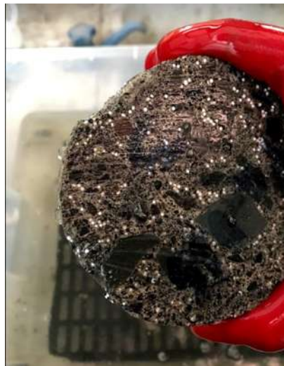
Ilustración 32. Extracción de los especímenes de la solución de \text{Na}_2\text{SO}_4 en un intervalo de tiempo entre 16h y 18h. (García Chávez, 2019)
