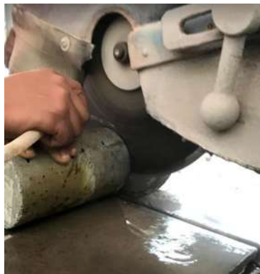
Ilustración 28. Cortadora de roca para extracción de rodajas de 5cm x 10cm. (García Chávez, 2019)
