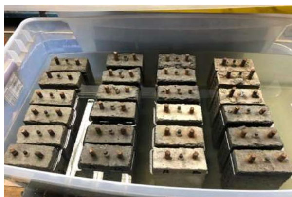
Ilustración 24. Especímenes inmersos en solución salina. (García Chávez, 2019)
