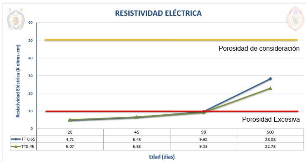
Ilustración 61. Comparación de especímenes elaborados de concreto con agregado pétreo convencional y con relación a/c 0.45 y 0.65.
