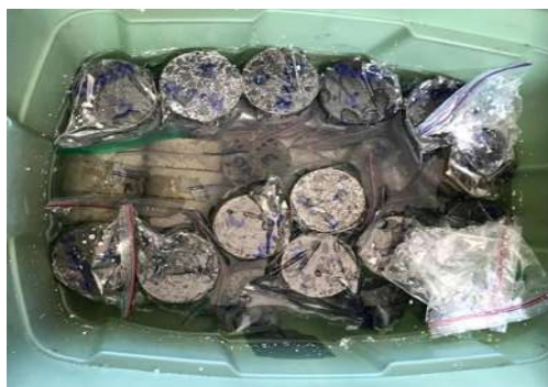
Ilustración 47. Tina de curado en la cual se mantuvieron las rodajas hasta el momento de su prueba. (García Chávez, 2019)
