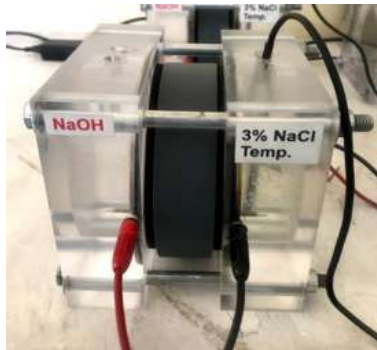
Ilustración 45. Terminales positivo y negativo respectivamente, así como medidor de temperatura en la solución de NaOH. (García Chávez, 2019)
