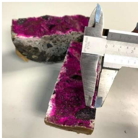
Ilustración 40. Medición de la carbonatación en mm, con ayuda de vernier. (García Chávez, 2019)
