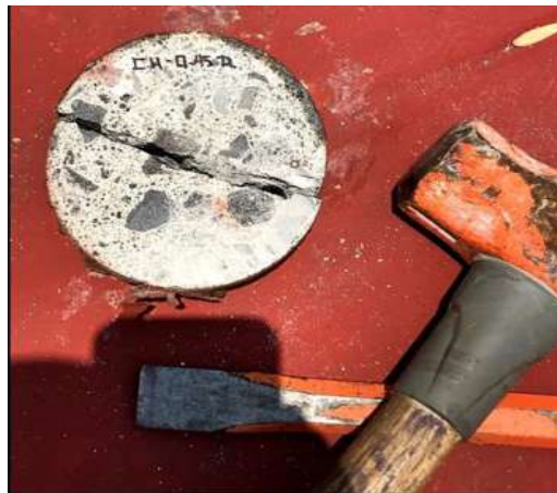
Ilustración 37. Corte transversal del espécimen con ayuda de marro y cincel. (García Chávez, 2019)
