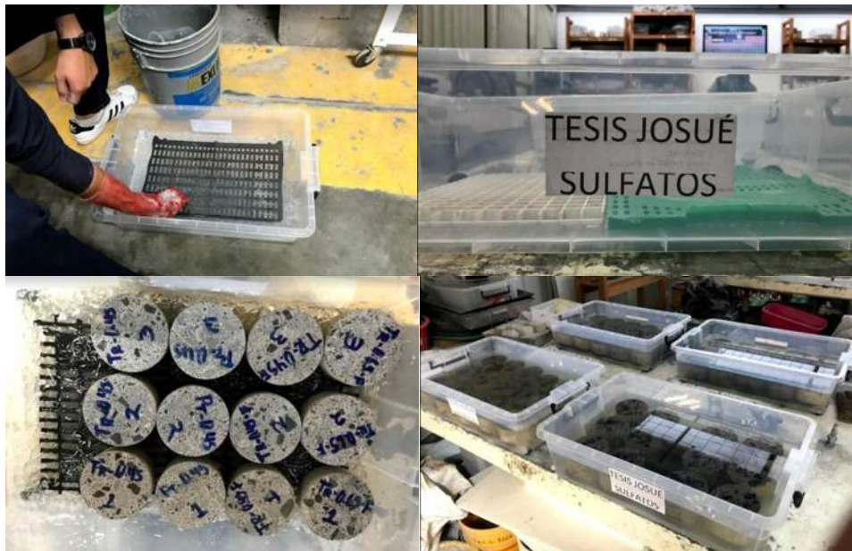
Ilustración 31. A la izquierda arriba: Preparación de recipientes de plástico con solución de \text{Na}_2\text{SO}_4 , A la derecha arriba: Colocación de rejillas de plástico para evitar contacto de las rodajas con el fondo del recipiente. Izquierda abajo: Colocación de los especímenes sobre la solución de \text{Na}_2\text{SO}_4 y de las rejillas de plástico. Derecha abajo: Colocación de \text{Na}_2\text{SO}_4 con un tirante >1.5\text{cm} por encima de las rodajas, con la finalidad de que estas queden sumergidas en la salmuera. (García Chávez, 2019)
