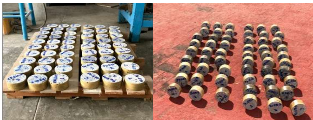
Ilustración 36. A la izquierda: 54 rodajas de concreto con cubierta de parafina. A la derecha: rodajas expuestas a la intemperie en dirección suroeste para tener contacto directo con CO 2 . (García Chávez, 2019)
