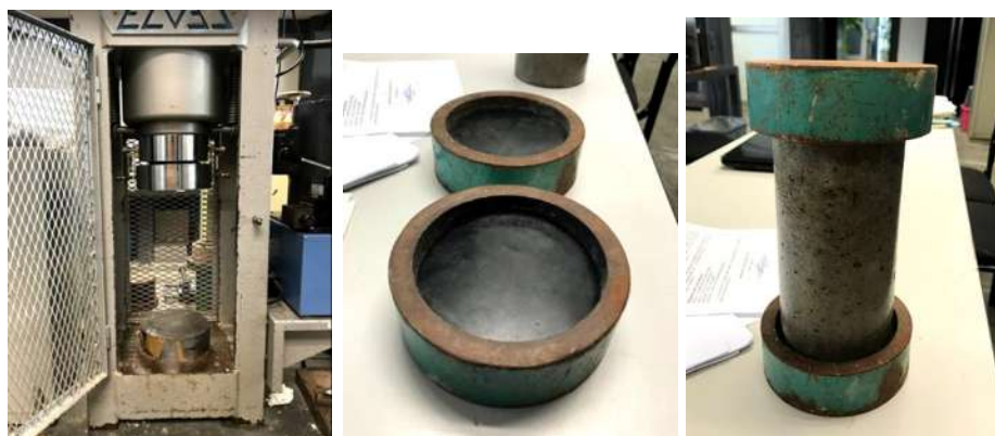
Ilustración 21. A la izquierda: Máquina de carga axial. Al centro: Placas de neopreno para dar uniformidad a la superficie de la probeta. A la derecha: Cilindro con placas de neopreno. (García Chávez, 2019)
