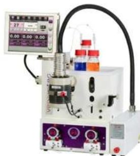
Figura 27. Equipo de química de flujo con reactor y lámpara acoplado.
