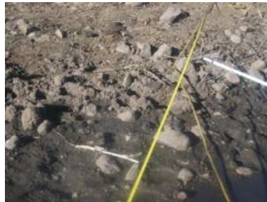
Figura 5. Colocación de la cuerda y cintas para la medición de atributos geomorfológicos.
