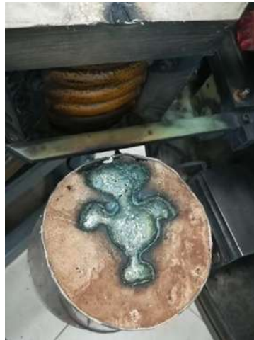
Figura 3.9 Pieza solidificada a velocidad de enfriamiento controlada dentro del horno
