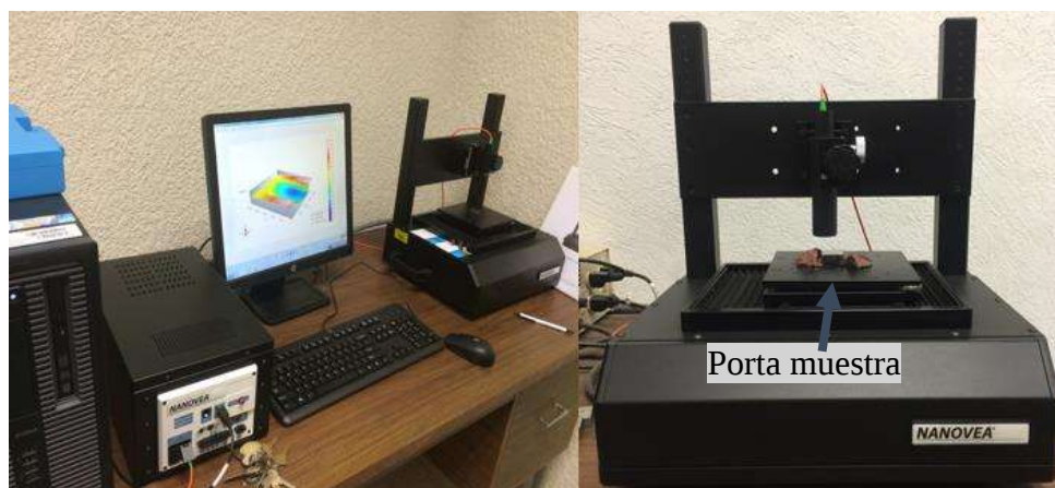
Figura 3.17 Perfilómetro de no- contacto para calcular la pérdida de volumen
