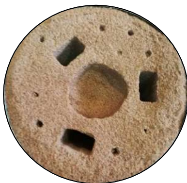
Figura 3.7 Vista superior del molde de arena.
