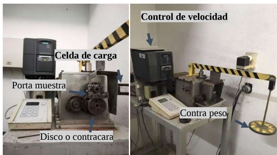
Figura 3.15 Equipo de desgaste con geometría pin-on-ring.
