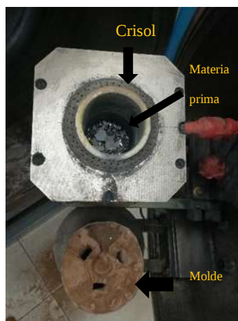
Figura 3.8 Preparación de elementos para la fundición
