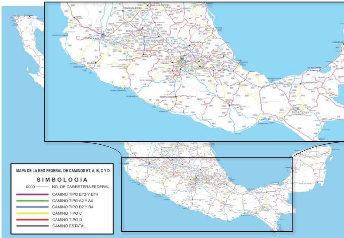
Fig. 1-10 Mapa de la Red Federal de carreteras ET, A, B, C y D, obtenido de: (CANACAR, 2016).
