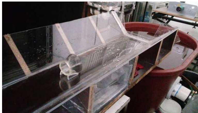
Figura 4.9: Construcción del modelo del canal
