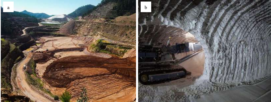
Fig. 2.9 Tipos de minas a Mina de oro a cielo abierto, Pinos Altos, Chihuahua, México y b Mina subterránea, Tajo Prometeo, Coahuila, México [100, 101].
