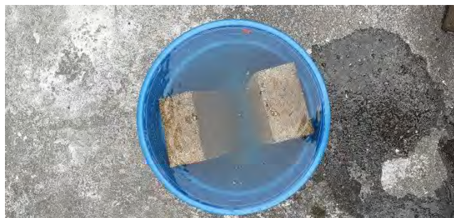
Figura 19. Bloques sumergidos en agua por 24 horas.
