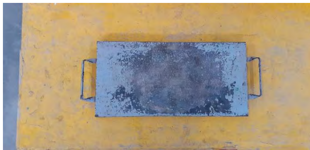
Figura 25. Placa de asiento colocada sobre los bloques al momento de realizar la prueba.
