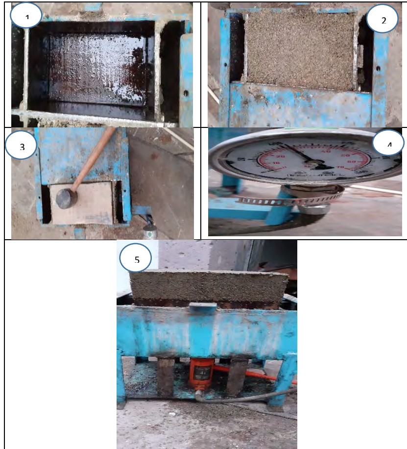
Figura 14. Obtención del bloque de material compuesto por medio de una prensa fabricada. 1) Lubricación para fácil desmolde. 2) Vertido de mezcla en el molde. 3) Compactación de la mezcla. 4) Prensado del bloque a 30 kg/cm 2 . 5) Obtención del bloque.
