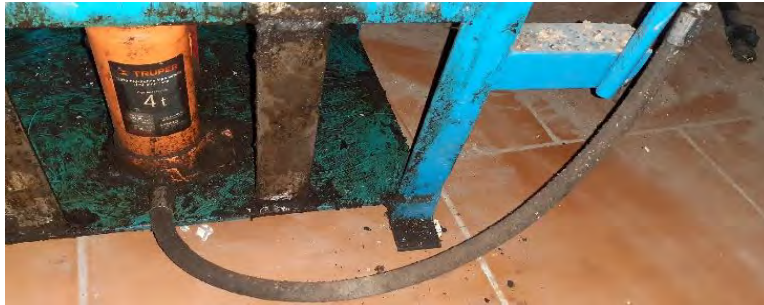
Figura 56. Manguera hidráulica de 2000 psi de resistencia.
