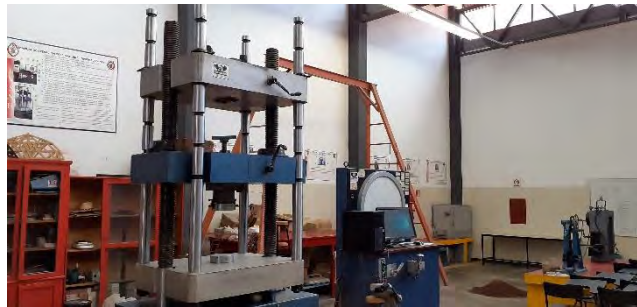
Figura 20. Máquina universal marca "Forney" utilizada para la prueba de compresión.
