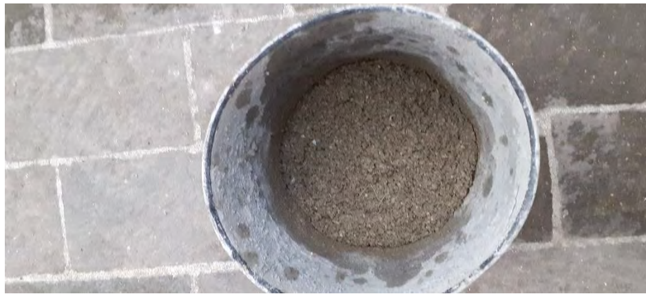
Figura 11. Aserrín, cemento, engrudo y agua ya mezclados dando como resultado la mezcla para fabricación del bloque.
