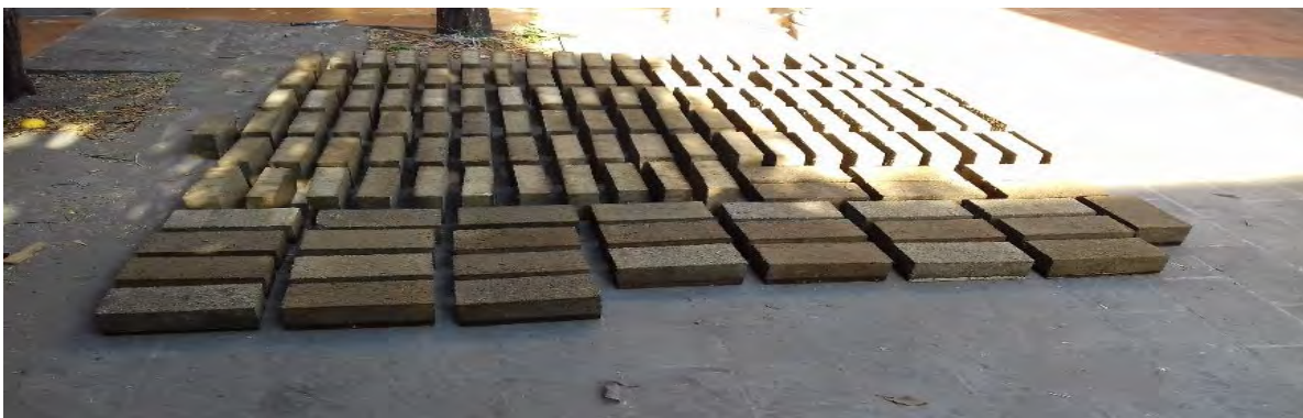
Figura 15. Bloques fabricados para caracterización física y mecánica.
