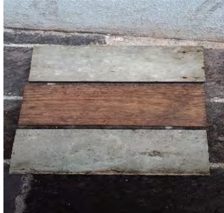
Figura 12. Tablas para soportar la mezcla en la prensa.
