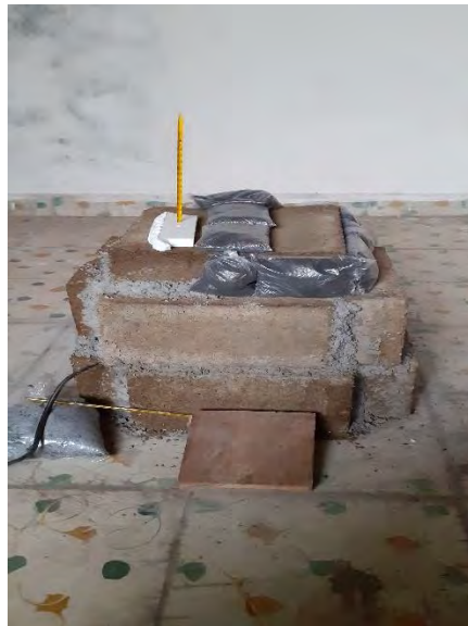
Figura 34. Cámara utilizada para estimar el aislamiento térmico del bloque de material compuesto.
