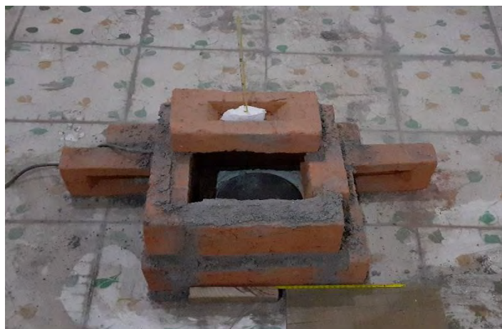
Figura 33. Cámara utilizada para estimar el aislamiento térmico del tabique de barro recocido
