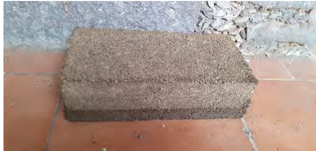
Figura 18. Bloque sometido a prueba de absorción máxima inicial de agua.
