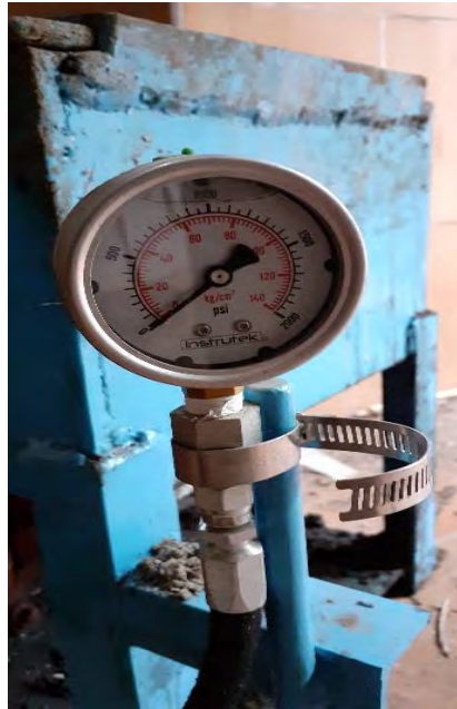
Figura 59. Manómetro de 2000 psi de capacidad marca "Instrutek".
