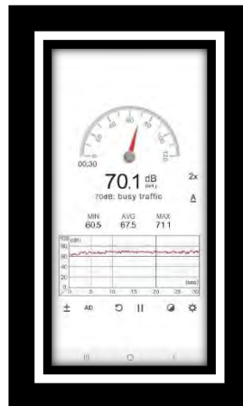
Figura 31. Interfaz de la aplicación "sonómetro" con la que se estimó el aislamiento acústico.
