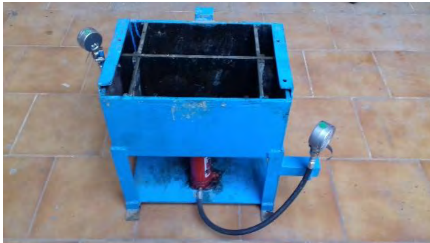
Figura 62. Prensa hidráulica fabricada para la producción del material compuesto propuesto.
