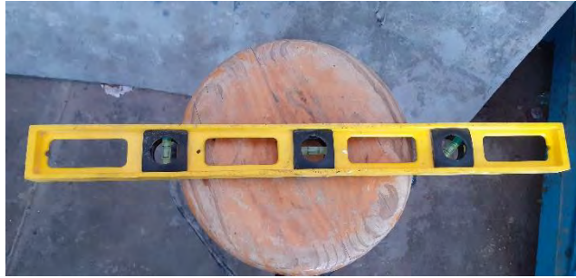
Figura 24. Nivel usado para el correcto cabeceo de las muestras.
