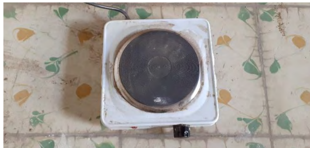
Figura 35. Parrilla utilizada para realizar la estimación del aislamiento térmico.
