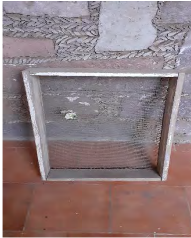
Figura 5. Criba con malla comercial de 5 x 5 mm.
