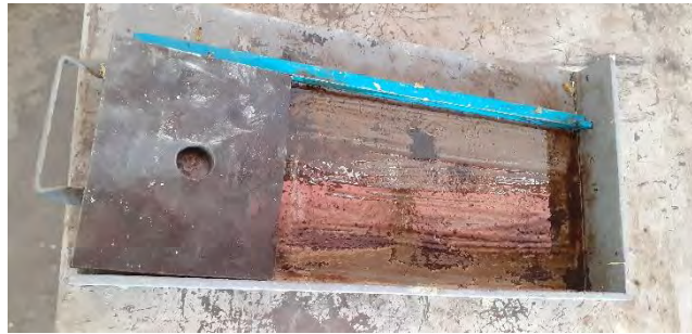
Figura 22. Placa de cabeceo utilizada en el proceso y escuadra de límite.
