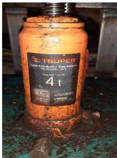
Figura 58. Gato hidráulico de 4 toneladas de capacidad marca “Truper”.
