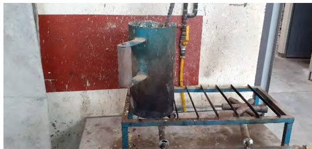
Figura 21. Preparación de azufre para cabeceo de las piezas a comprimir.
