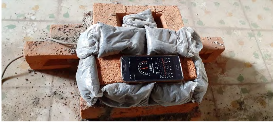
Figura 32. Detalle de la prueba de estimación del aislamiento acústico para el tabique de barro recocido.
