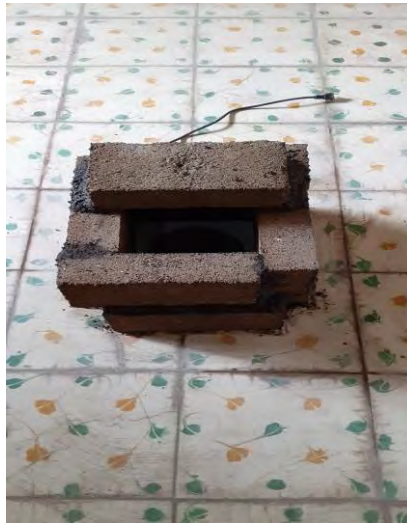
Figura 29. Cámara elaborado para estimar el aislamiento acústico del material compuesto.
