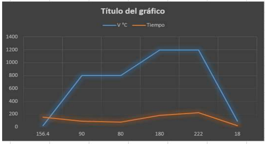
Figura 56. Curva de temperatura para la sinterización convencional
