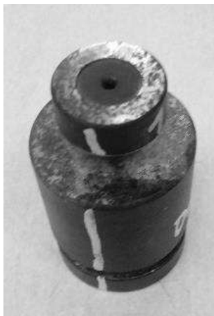
Figura 52. Punzón introducido para la compactación de las probetas
