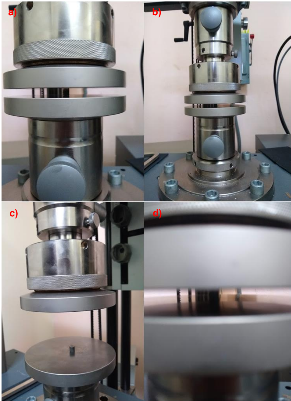
Figura 114. Ensayo de compresión de espumas metálicas de base Titanio
