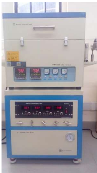
Figura 12. Horno a temperatura de 730°C con gabinete de control del suministro de los gases, Argón y Etileno
