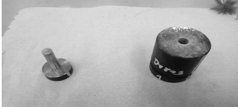
Figura 50. Matriz lubricada con estearato de zinc
