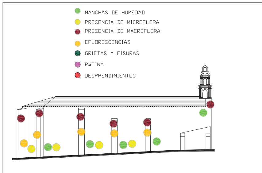
Figura 22.- Representación de deterioros principales en el muro norte de la nave del templo.
