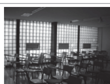
Imagen 78. Vista interior de las aulas. Los muros son de block de vidrio.
