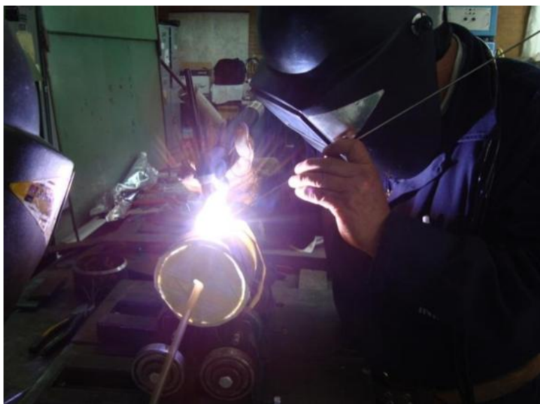
Figura 2.3 Soldadura de la unión disímil por el proceso GTAW.
