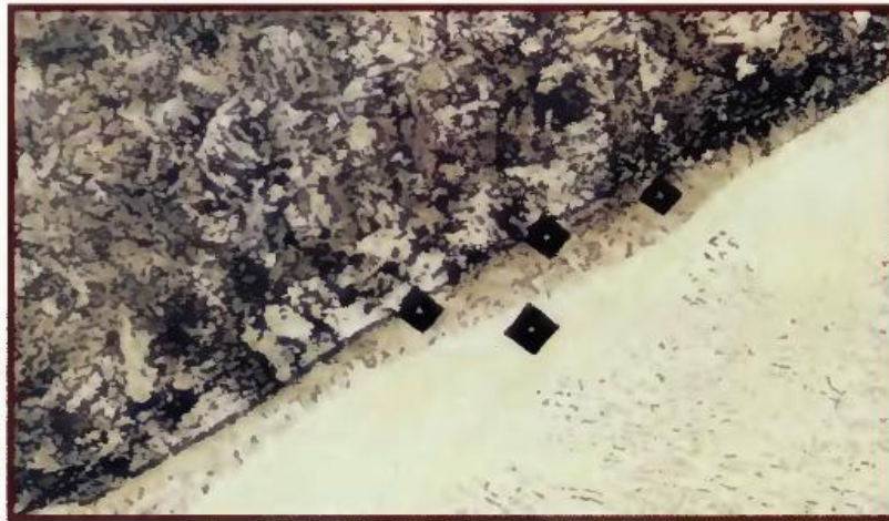
Figura 1.18 Estructura tipo playa en la región de transición observada a 240X [99] .
