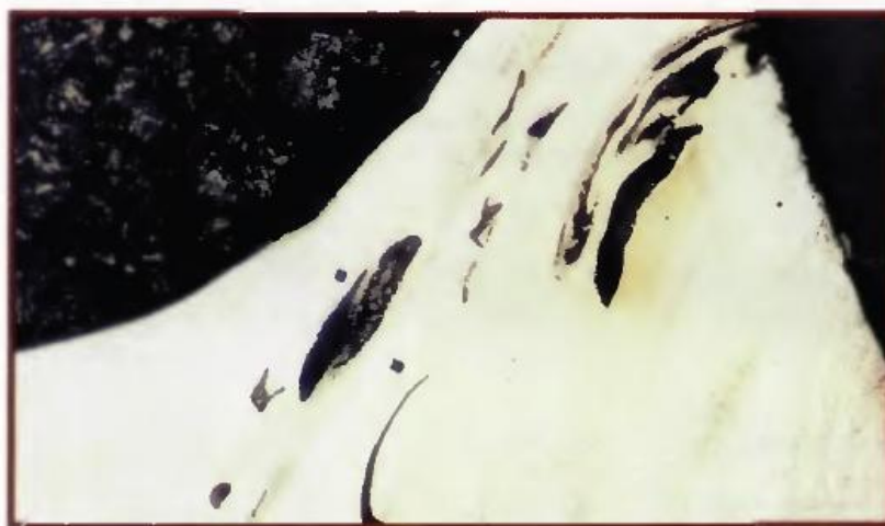
Figura 1.20 Estructura tipo isla en la región de transición observada a 60X [99] .
