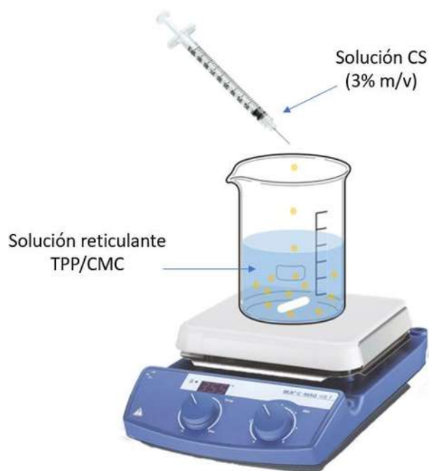
Figura 3.2 Esquema del sistema de goteo.
