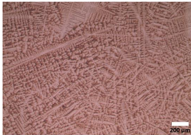
Figura 4.16 Microestructura en condición de solidificación para el acero Fe-27Mn-7Al-1.2C-0.019Ti-0.0053B.
