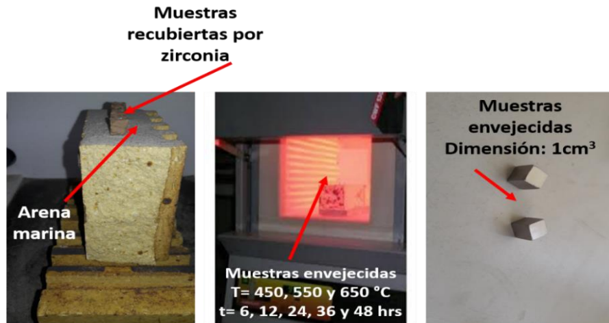
3.16 Proceso del tratamiento térmico de envejecimiento.
