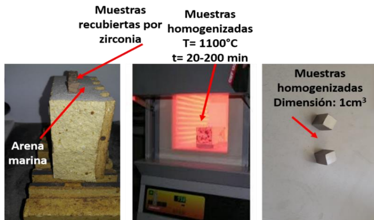
Figura 3.11 Tratamiento térmico de homogenizado en horno RHF 1500 CARBOLITE.
