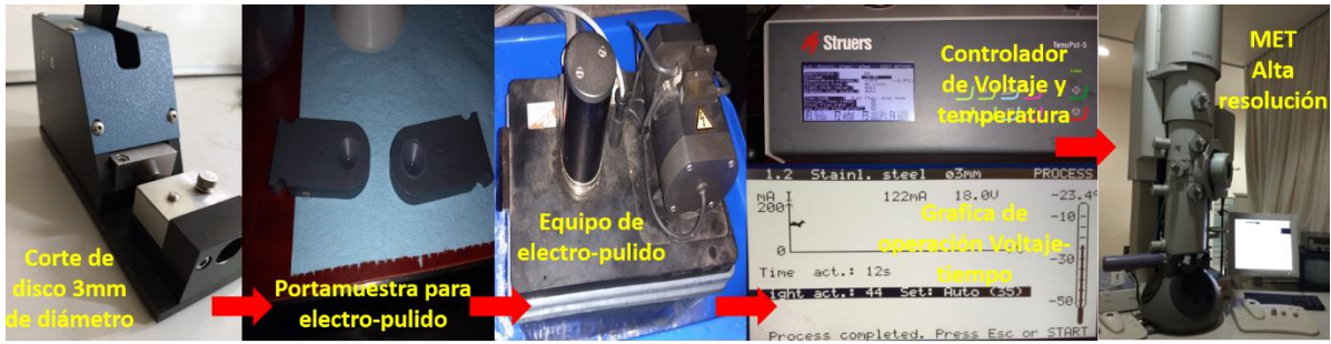
Figura 3.26 Procedimiento para la obtención de imágenes en alta resolución (HRTEM).
