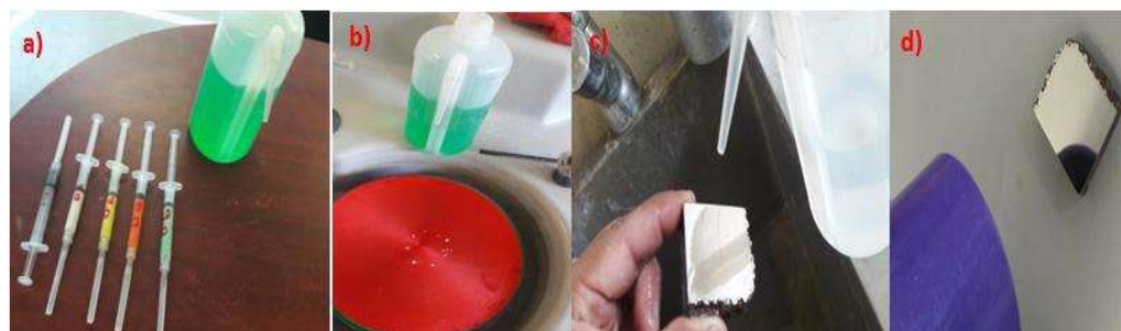
Figura 3.18 Diferentes etapas de la preparación metalográfica de muestras. a) Pasta de diamante, b) Pasta de diamante en paño con lubricante, c) Limpieza con alcohol, d) Secado con aire frío.
