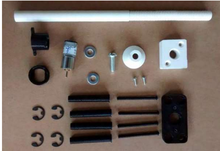
Fig. 8.1. Piezas impresas y comerciales del prototipo del Pie.
