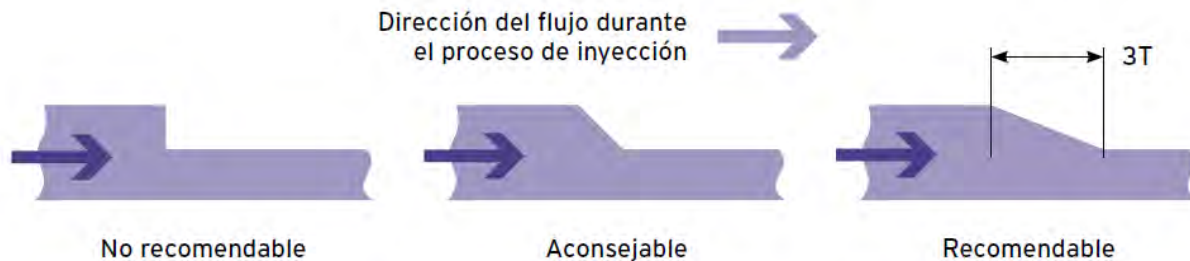
Fig. 7.3. Transición gradual en espesor de pared [14].
