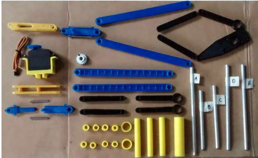
Fig. 8.3. Piezas impresas y comerciales del prototipo de la Pierna.
