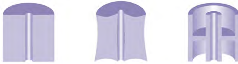
Fig. 7.12. Ejemplo de vaciado de pieza [14].
