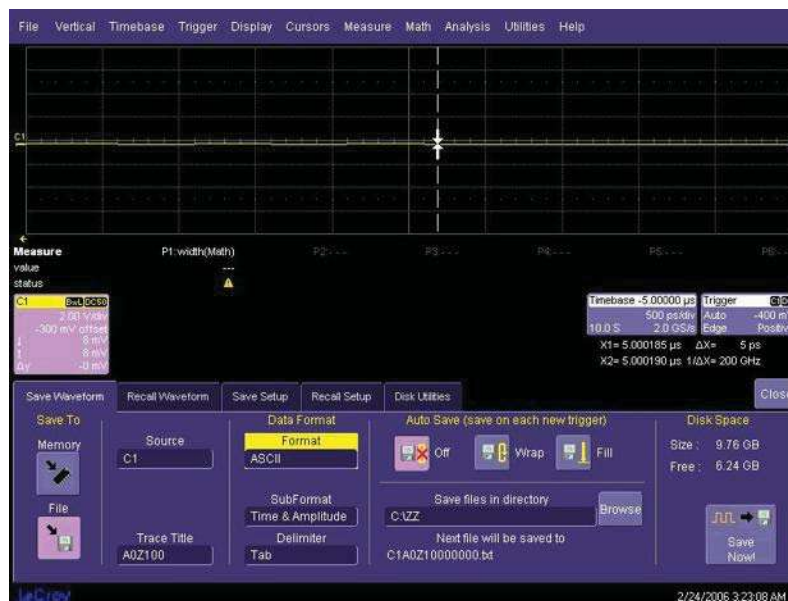
Figura 2.8. Definición de Parámetros de Almacenaje.
