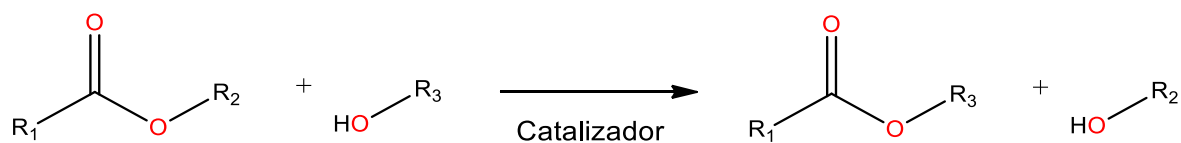
Esquema 1. Reacción de transesterificación
