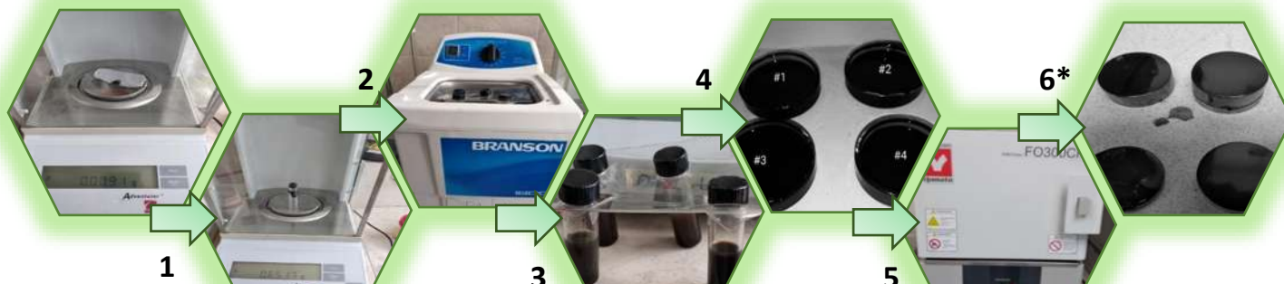
Figura 25 Preparación de Compósitos de Nano estructuras de carbono/ cis -1,4-poliisopreno: 1-2) pesaje de la muestra, 3) baño ultrasónico de la mezcla, 4-5) evaporación del solvente, 6) obtención de películas de CNS/ cis -1,4-poliisopreno.
