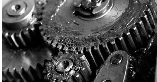
Figura 8. Desgaste de engranaje causado por una constante carga cíclica.
