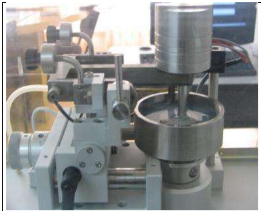
Figura 3.2. Esquema del tribómetro espiga-disco usado.
