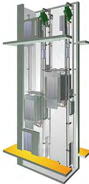
Fig. 1.7 Esquema de elevador sin cuarto de máquina cortesía de Kone, Inc. [27]
