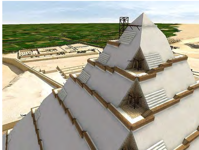
Fig. 1.11 Imagen de una simulación digital que reproduce la construcción de la pirámide de Keops en Egipto, según el arquitecto francés Jean-Pierre Houdin [29]
