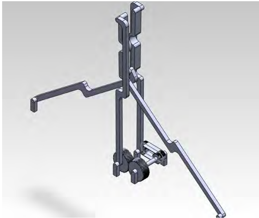
Fig. 3.26 Arreglo entre mecanismos de Chebyshev.
