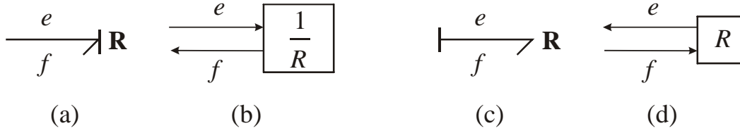
Figura A.6: Elementos puerto-1 lineales, representación de elementos-R, (a) un bond graph con esfuerzo de entrada, (b) un diagrama a bloques con esfuerzo de entrada; (c) un bond graph con flujo de entrada, y (d) un diagrama a bloques con flujo de entrada.
