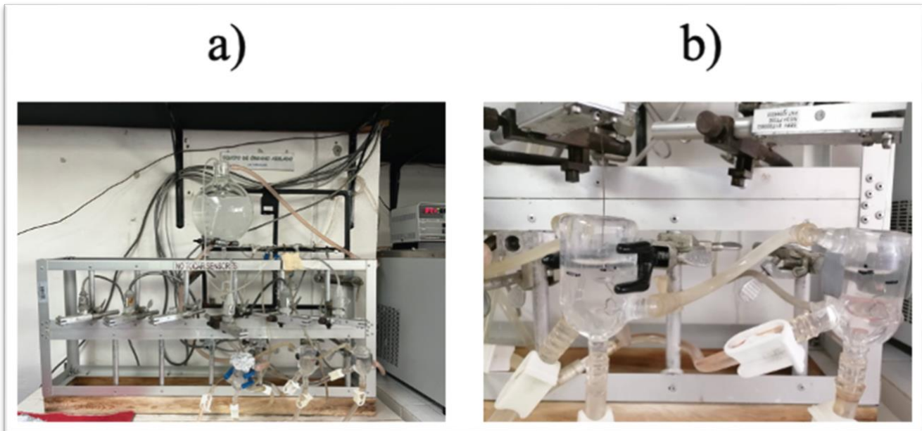
Figura 14. a) Equipo de órgano aislado y b) cámaras para tejido aislado.
