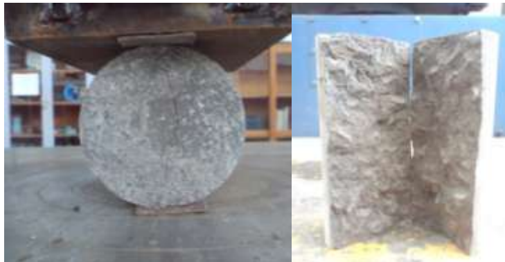
Figura . Falla por Tensión Diametral en Cilindros.
