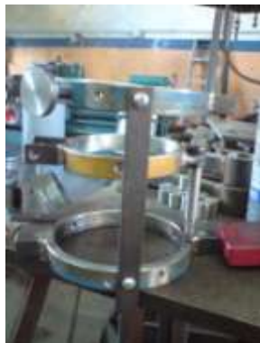
Figuras . Equipo Fabricado para determinar el Módulo Elástico en Cilindros de 10x20 cm
