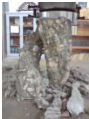
Figura . Falla de Ruptura en Especimen.
