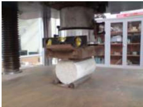
Figuras . Prueba de tensión y corte longitudinal debido a falla por compresión diametral.
