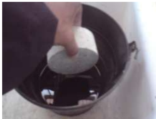
Figura . Preparación de Especímenes con parafina.
