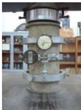
Figura . Especimen instrumentado para Determinar el Módulo de Elasticidad.
