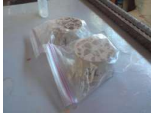
Figuras . Preparación de Especímenes para congelamiento y deshielo.
