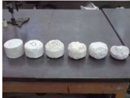
Figuras . Especímenes después de 0,100, 200, 300, 400 y 500 revoluciones.
