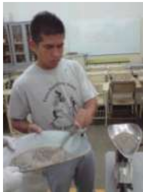
Figura . Pesaje de muestra de cemento.
