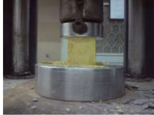
Figura . Determinación de la resistencia de los cubos de Azufre.
