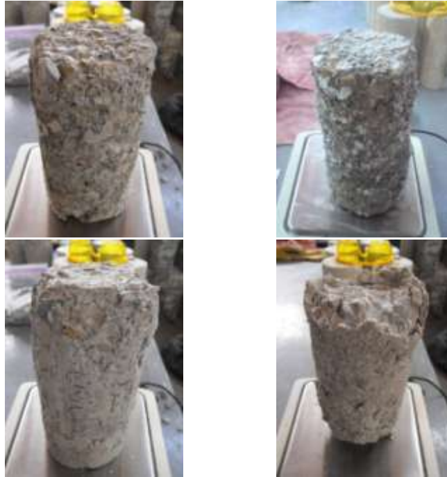
Figuras . Especímenes CT050, CT065, CZ050 y CZ065 después del Quinto Ciclo de ataque acelerado por sulfatos.
