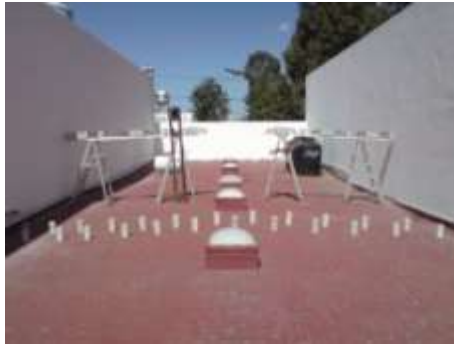
Figuras . Especímenes expuestos a la atmósfera y señalización de dirección sur respectivamente.
