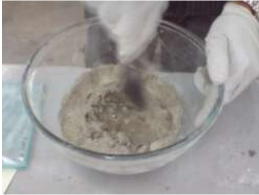
Figura . Mezclado de muestra de cemento.
