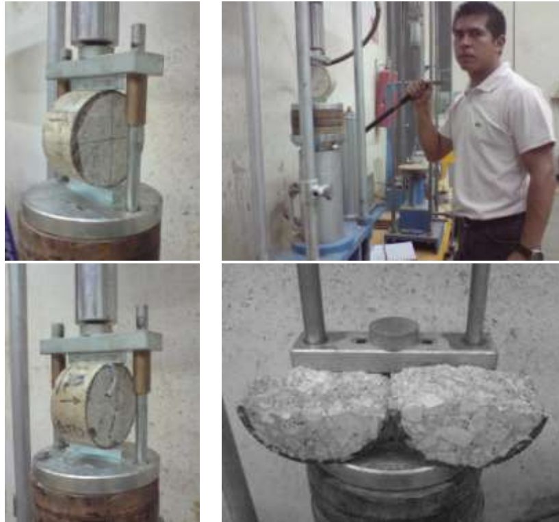
Figuras . Determinación de la resistencia a compresión diametral en Especímenes.
