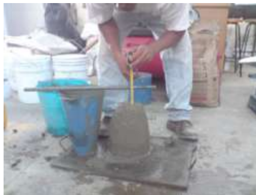
Figura . Determinación del Revenimiento.
