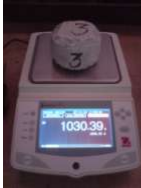
Fig . Pesado de muestra después de 100 revoluciones.
