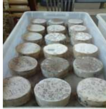
Figura . Tirante de agua de 3mm.
