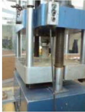
Figura . Aplicación de Carga hasta la Ruptura para Determinar el Módulo de Elasticidad.
