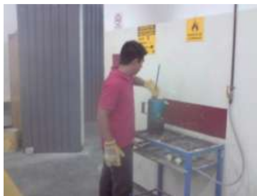
Figura . Fundido de mortero de Azufre.
