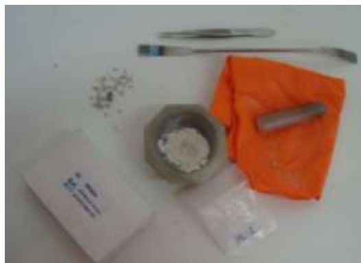
Figura . Maceración manual de las pastillas de concreto.
