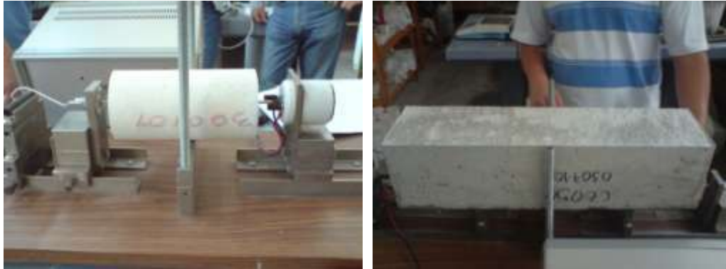
Figura . Montaje de Especimen cilíndrico y Prismático para prueba de resonancia.
