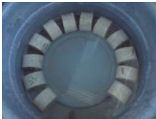
Fig . Saturado de Especímenes para congelamiento y deshielo.
