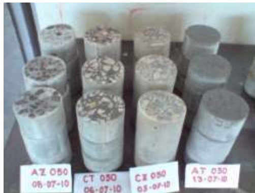
Fig . Especímenes para congelamiento y deshielo.
