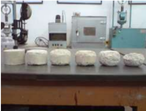
Figuras . Especímenes después de 0,100, 200, 300, 400 y 500 revoluciones.
