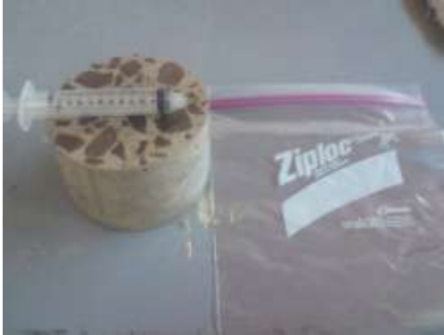
Figuras . Preparación de Especímenes para congelamiento y deshielo.
