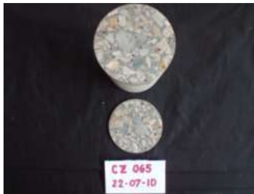
Figura . Corte de especímenes para Microscopía Electrónica de Barrido.
