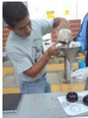
Figura . Llenado del matraz Lechatelier con keroseno.
