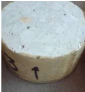
Figura . Especimen de prueba Fagerlund.
