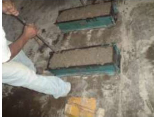
Figura . Varillado del concreto en el molde.
