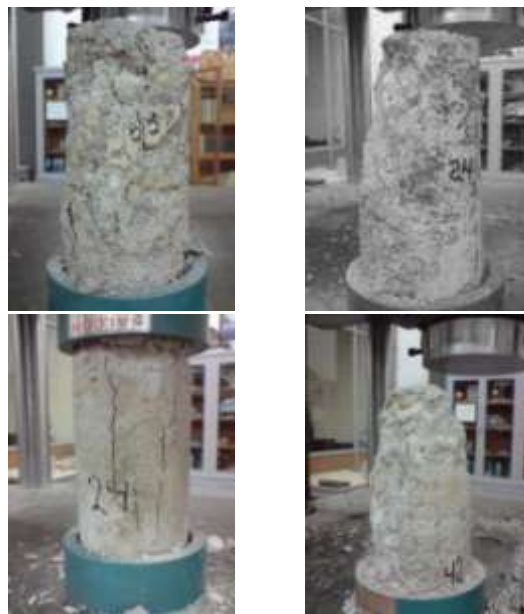
Figuras . Especímenes CT050, CT065, CZ050 y CZ065 después de aplicar la compresión axial.
