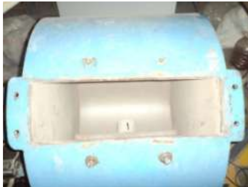
Fig . Colocado de muestra en maquina de desgaste de los ángeles.
