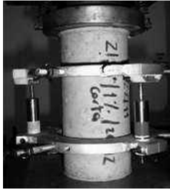
Figura . Colocación del dispositivo para medición del Módulo de Elasticidad del Concreto.
