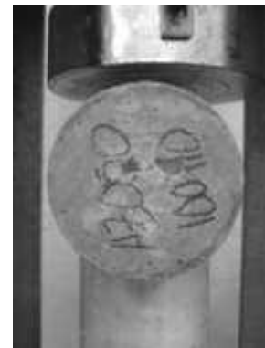
Figura . Daños presentes en especimen después de la prueba de rebote.
