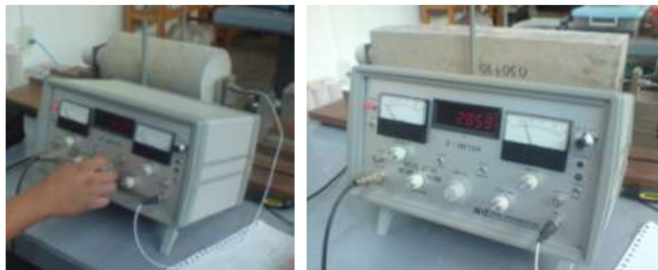
Figura . Obtención de frecuencia de resonancia en espécimen Cilíndrico y Prismático.
