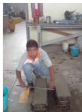
Figura . Enrasado de los especímenes.
