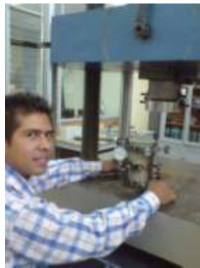
Figura . Revisión de Micrómetros para Determinar el Módulo de Elasticidad.
