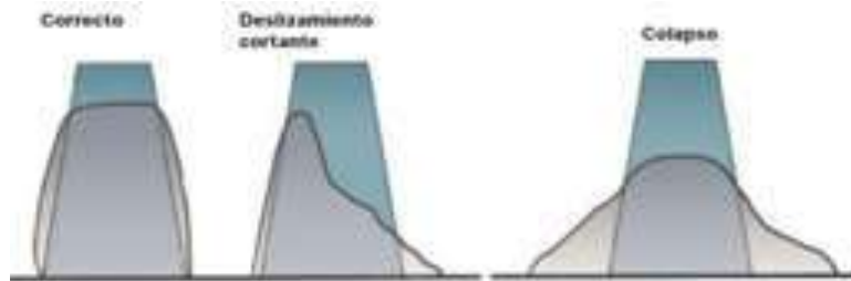
Imagen 5. Fallas en el Revenimiento.
