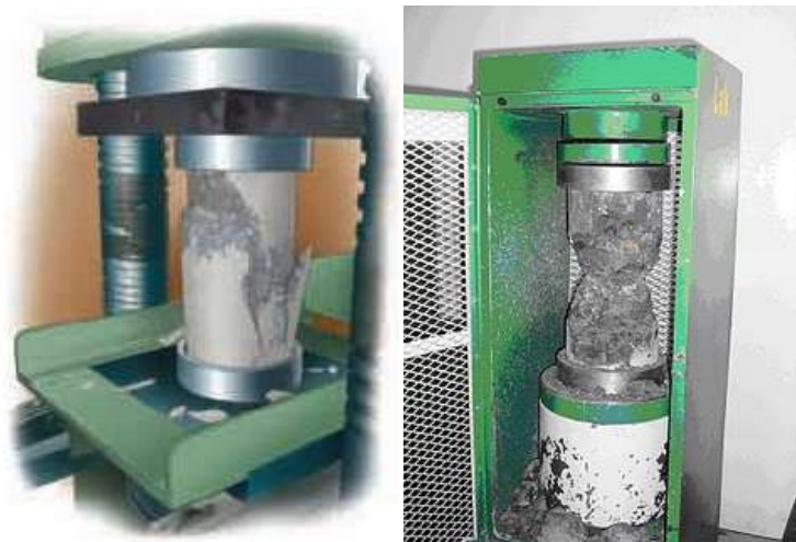
Figura . Falla por compresión en Cilindros de Concreto.
