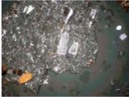
Figura . Fotografía realizada con Nícoles Cruzados a 4X de Plagioclasas y Augita.
