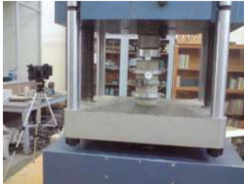
Figura . Toma de fotografías en infrarrojo durante la determinación del Módulo Elástico.
