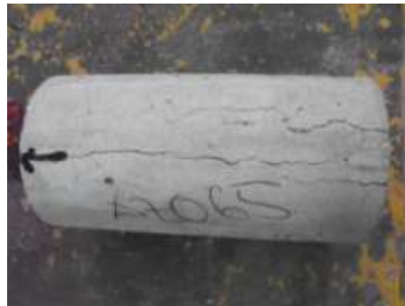
Figuras . Prueba de tensión y corte longitudinal debido a falla por compresión diametral.
