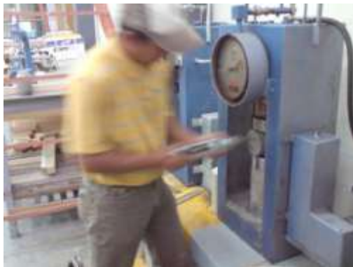
Figura . Acomodo de especimen para obtener el rebote esclerométrico con precarga.
