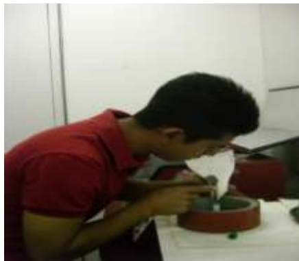
Figura . Vertido del agregado para su maceración mecánica.
