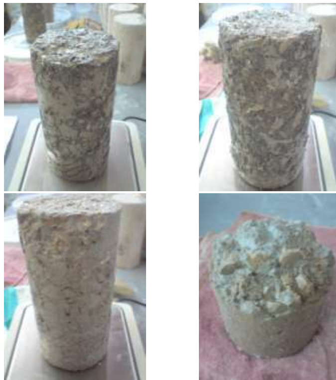
Figuras . Especímenes CT050, CT065, CZ050 y CZ065 después del Cuarto Ciclo de ataque acelerado por sulfatos.
