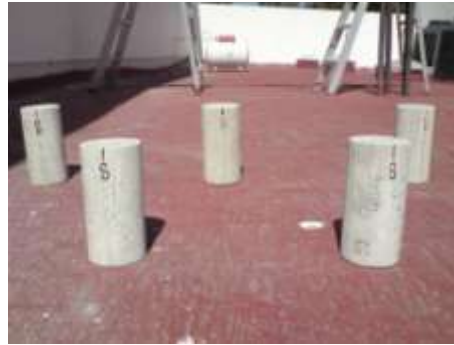
Figuras . Especímenes expuestos a la atmósfera y señalización de dirección sur respectivamente.
