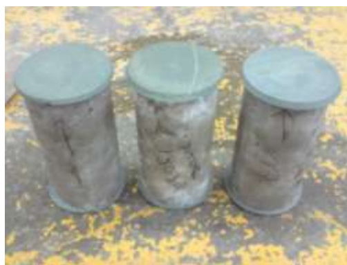
Figura . Especímenes Cabeceados y listos para prueba.
