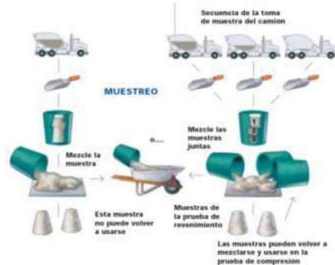
Figura . Secuencia de Muestreo de Camión Mezclador.
