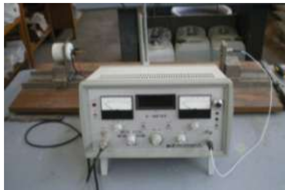
Figura . Sonómetro comercial para determinar frecuencias de resonancia
