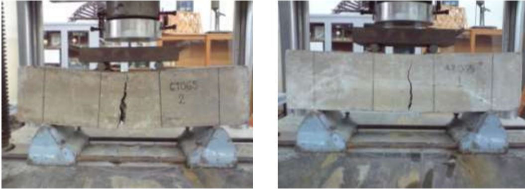
Figuras . Fallas obtenidas en cada uno de los especímenes de cada mezcla.
