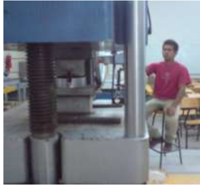
Figura . Aplicación de Carga a Especimen para Prueba de Tensión Diametral.
