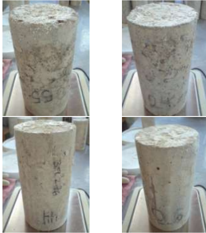
Figuras . Especímenes CT050, CT065, CZ050 y CZ065 después del Tercer Ciclo de ataque acelerado por sulfatos.
