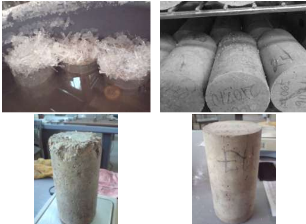
Figuras . Especímenes después de 16 hrs. de inmersión, Secado de especímenes, pesado de espécimen dañado y sin daños respectivamente (Segundo Ciclo).
