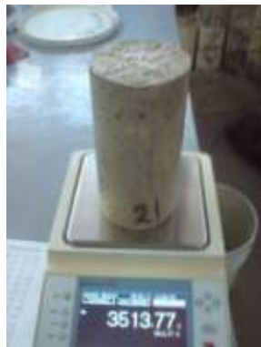
Figuras . Pesado de especímenes e inmersión de especímenes en solución saturada de sulfato de sodio.
