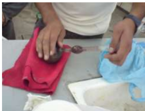
Figura . Desalojo de Aire del Matraz.
