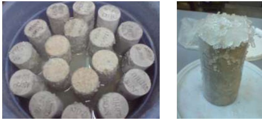
Figuras . Especímenes después de 16 hrs. de inmersión y espécimen con cristales de sulfato de sodio en su parte superior (Primer Ciclo).
