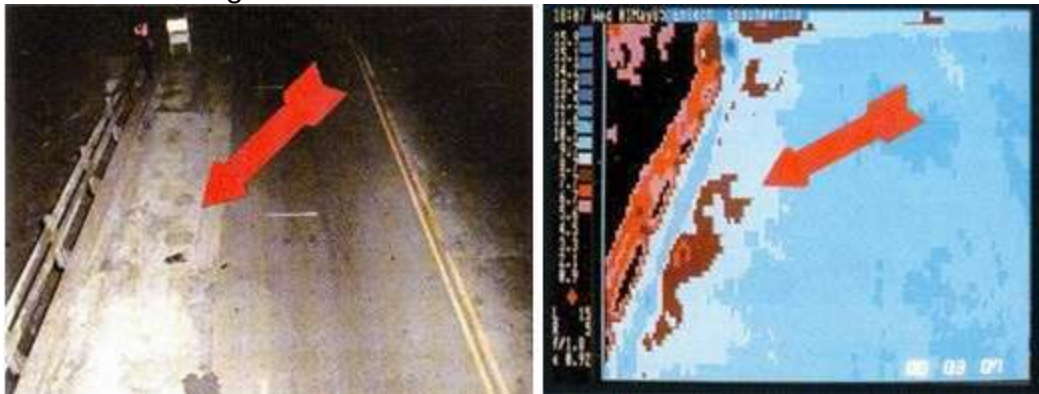
Figura . Imágenes Visual y térmica de concreto en polvo en el puente Martin Luther King en St. Louis, Missouri. Las áreas rojas en la imagen térmica representan concreto en polvo (Malhotra and Carino, 2004).
