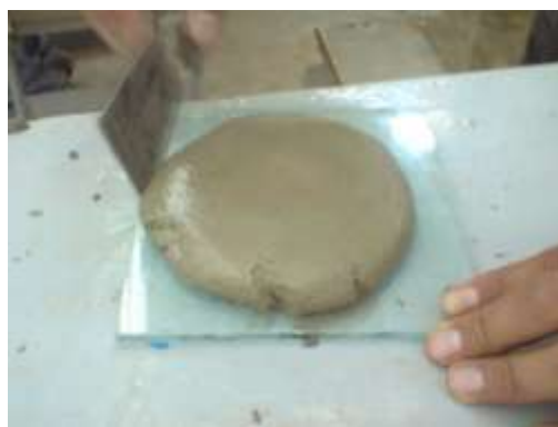
Figura . Preparación de muestra de cemento para determinar sus tiempos de fraguado.
