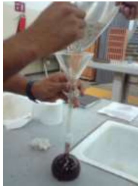
Figura . Baño maría del matraz Lechatelier con keroseno.
