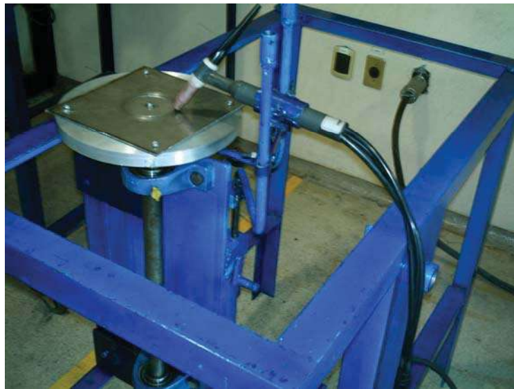
Figura 3.8 Equipo mecanizado para realizar soldaduras circulares.
