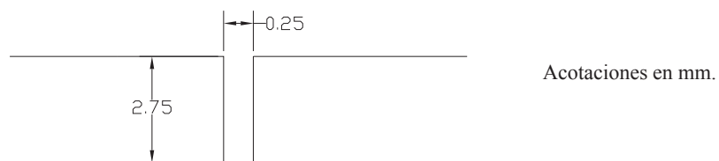
Figura 3.4 Perfil de las preparaciones de borde.
