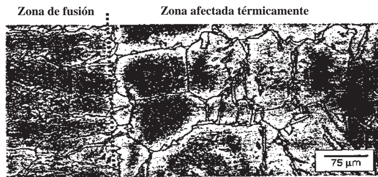
Figura 2.14 Microestructura de la ZAT en un acero inoxidable tipo 430. (Nótese la presencia de martensita en los límites de grano y gran precipitación intragranular) (2) .
