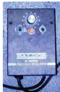
Figura 3.9 Variador de velocidad.
