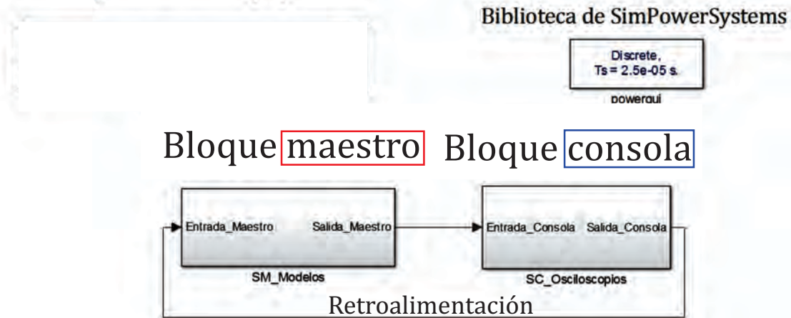
Figura 4.6: Estructura maestro y consola en Simulink para analizar formas de onda
