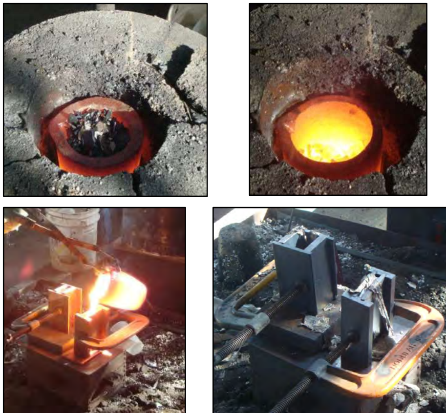
Fig 60. Fundición del material intermetálico Fe-Al.
