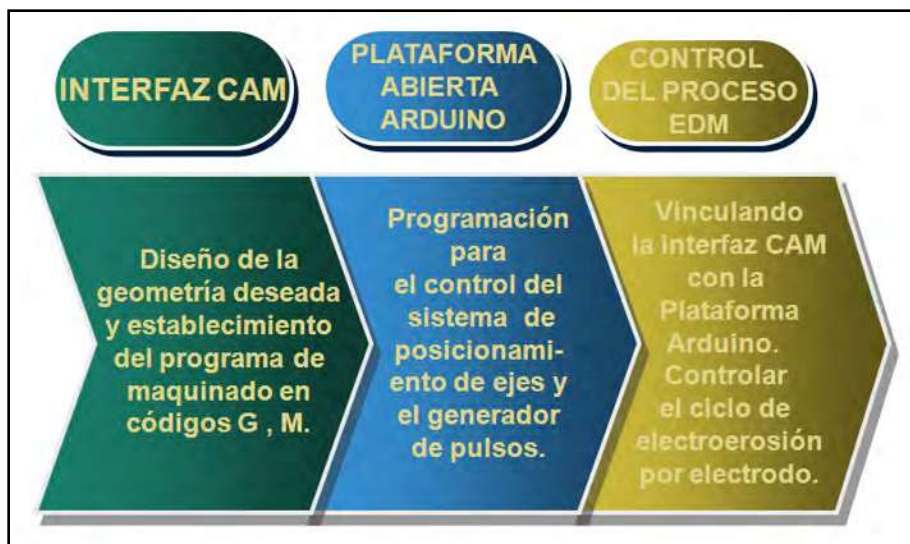
Fig 48. Diagrama de flujo para la implementación de la interfaz CAM.
