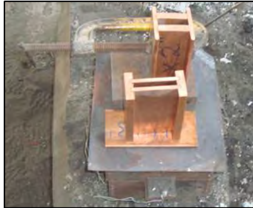
Fig 59. Moldes de cobre para la fundición del material intermetálico.
