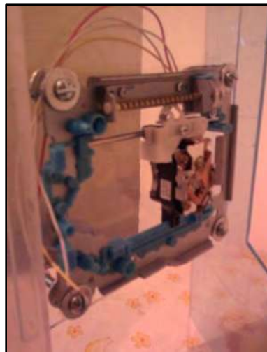
Fig 17. CD-ROM drive utilizado en el sistema de posicionamiento del centro de \mu EDM.
