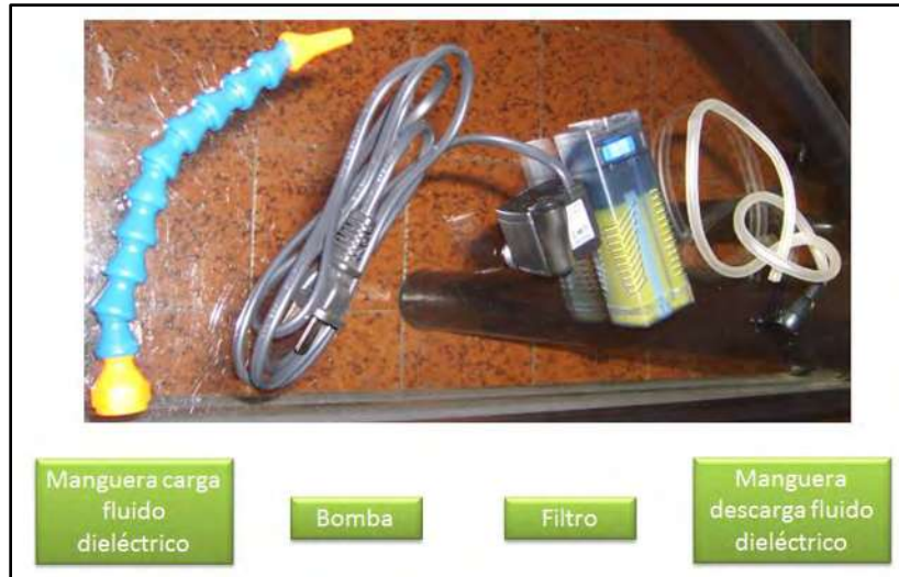
Fig 45. Sistema de circulación de la plataforma de \mu EDM.
