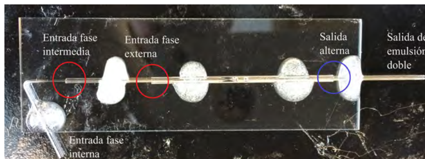
Figura 2.8: Montaje de los capilares sobre el portaobjetos para la fabricación del dispositivo microfluidico. Los círculos representan las zonas donde se colocan las puntas de infusión. El color rojo indica entrada de líquido y el azul, salida.
