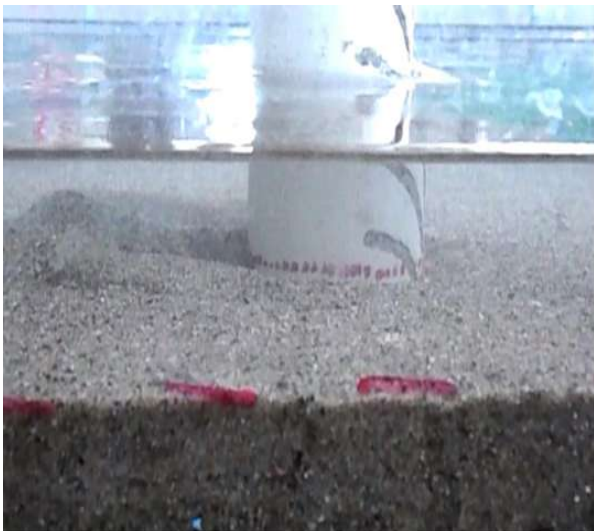
Figura 6.47 En esta prueba el diámetro del foso de socavación se percibe muy poco.
