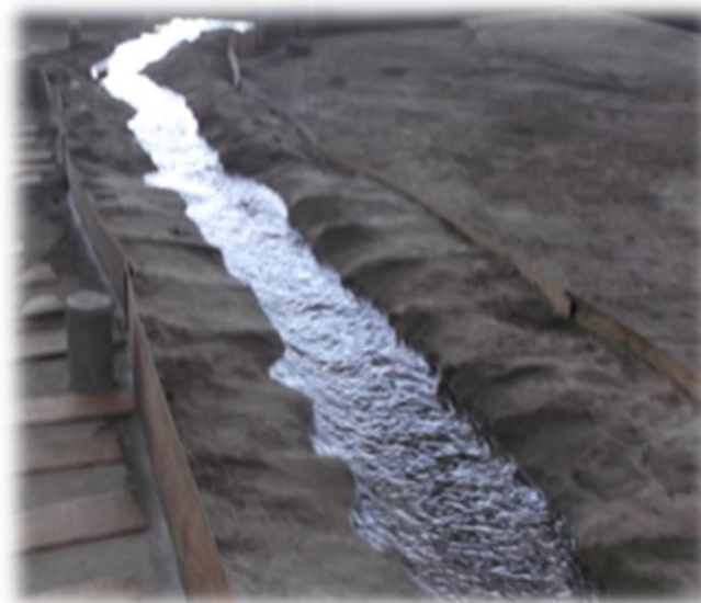
Figura 5.8 Prueba 3, flujo circulando en el modelo del río San Juan.
