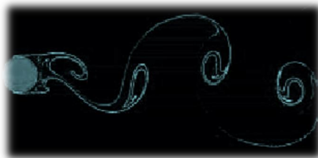
Figura 2.1 Inicio de la formación de vórtices de Von Kármán.
