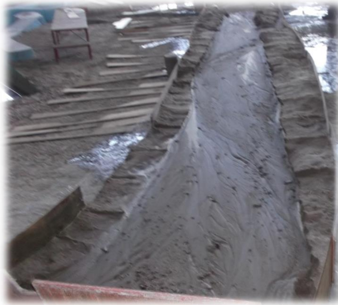
Figura 5.9 Secciones del río deformadas por el flujo de la prueba 3.
