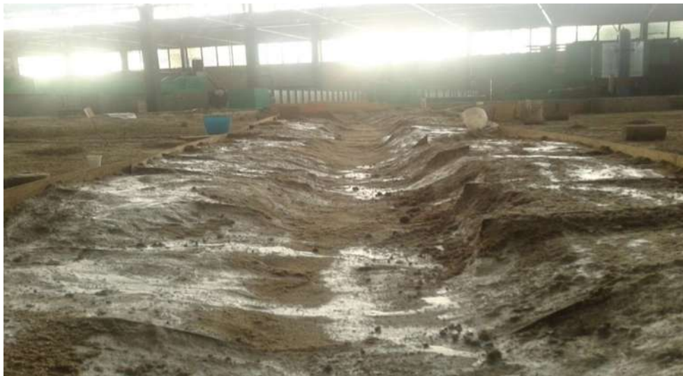
Figura 5.20 Fotografía en el fondo de una sección, que muestra las paredes estabilizadas del modelo.
