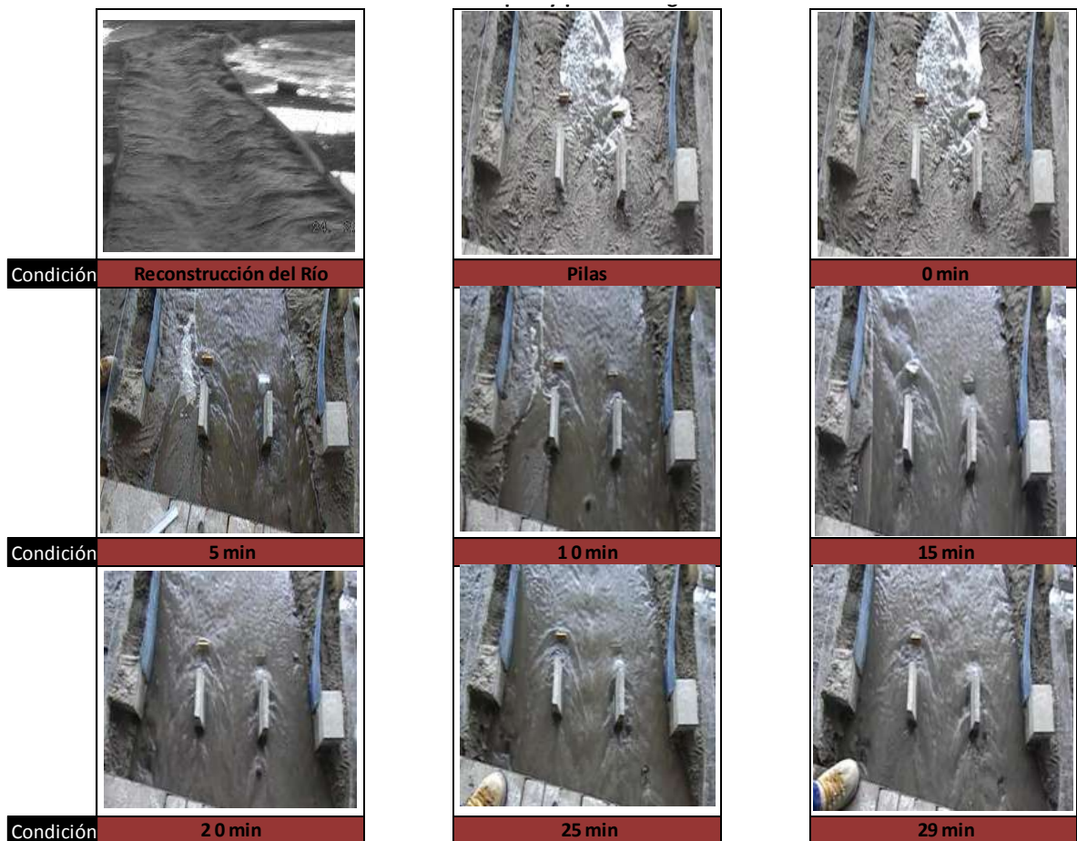
Figura 5.56 Prueba 1 con diques y pantallas aguas arriba, comportamiento del flujo con las pilas y estribos para Tr de 2 años.
