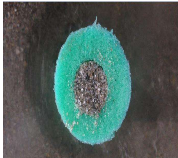
Figura 6.39 En esta prueba el diámetro del foso de socavación es de 2.05 cm
