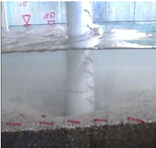
Figura 6.37 En esta prueba el diámetro del foso de socavación es de 2.80 cm.
