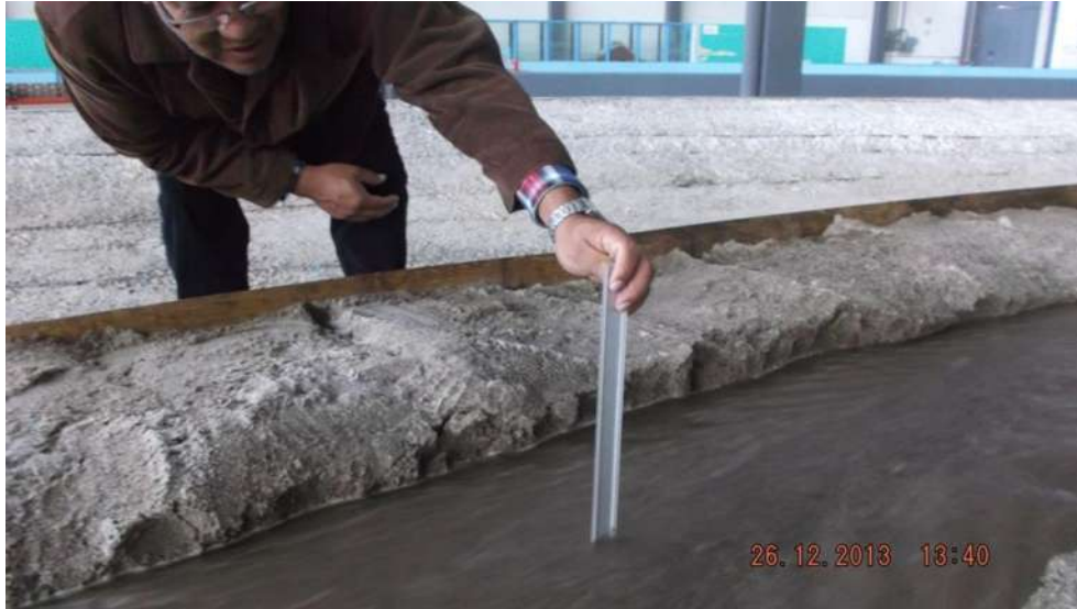
Figura 5.17 Medición del tirante.
