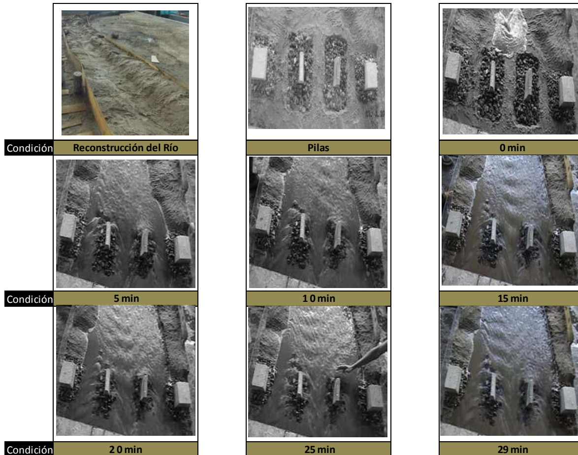
Figura 5.46 Prueba 2 con enrocado, comportamiento del flujo con las pilas y estribos para T_r de 2 años.
