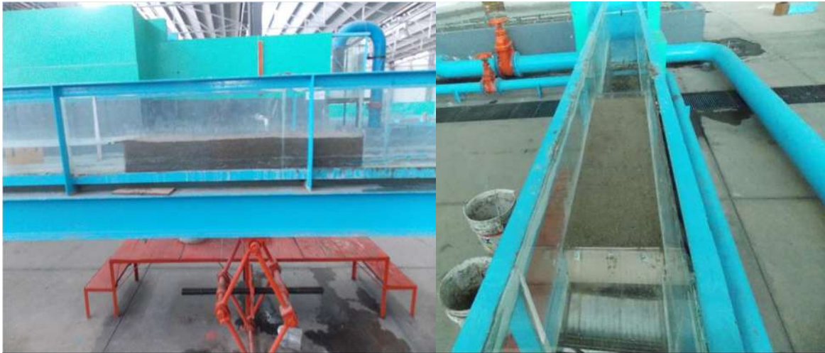
Figura 6.12 Foso de socavación colocado en el canal.
