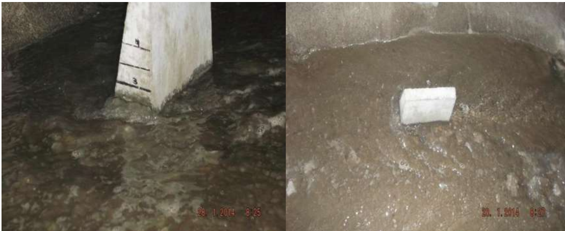
Figura 5.27 a) Remanso del flujo en la pila; b) Estela de vórtices.
