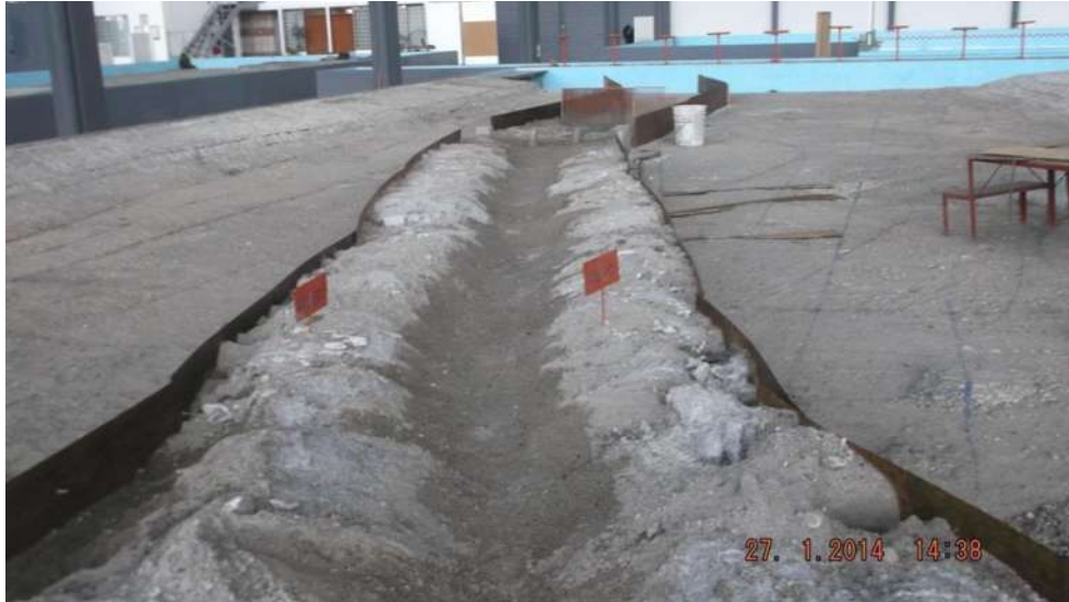
Figura 5.25 Modelo del río de San Juan reconstruido un día antes de la prueba.
