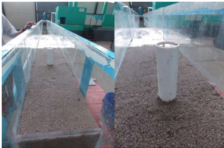
Figura 6.15 Nivelación del fondo de socavación y de la pila.
