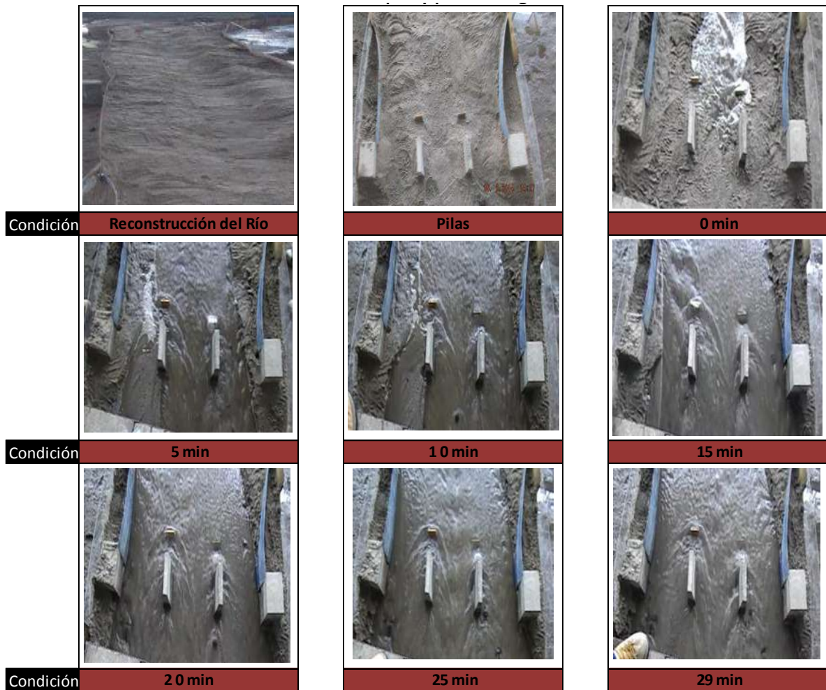
Figura 5.57 Prueba 2 con diques y pantallas aguas arriba, Comportamiento del flujo con las pilas y estribos para T_r de 2 años.
