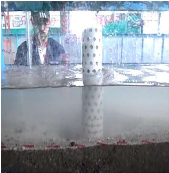
Figura 6.34 En esta prueba el diámetro del foso de socavación que se presenta es de 2.16 cm.
