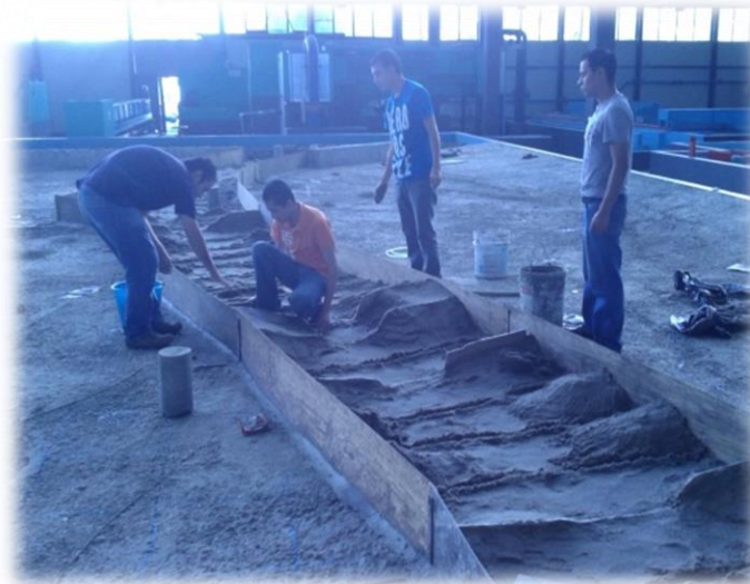
Figura 4.14 Colocación de las secciones transversales así como de la arena.
