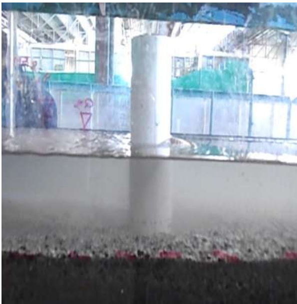
Figura 6.27 En esta Prueba el diámetro del foso de socavación que se presenta es de 2.7 cm.
