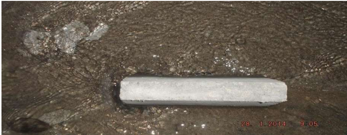
Imagen 5.30 Vista en planta de la estela de vórtices.
