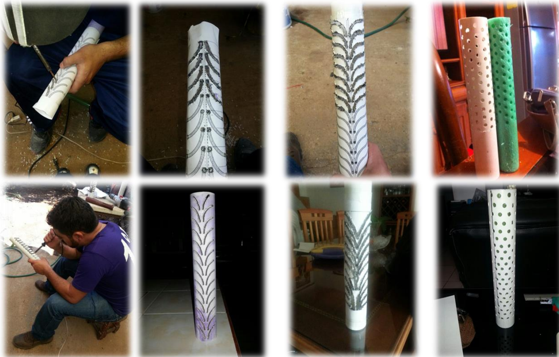
Figura 6.24 Elaboración de las rugosidades en las pilas.
