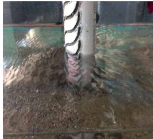
Figura 6.42 En esta prueba el diámetro del foso de socavación es de 1.88 cm.
