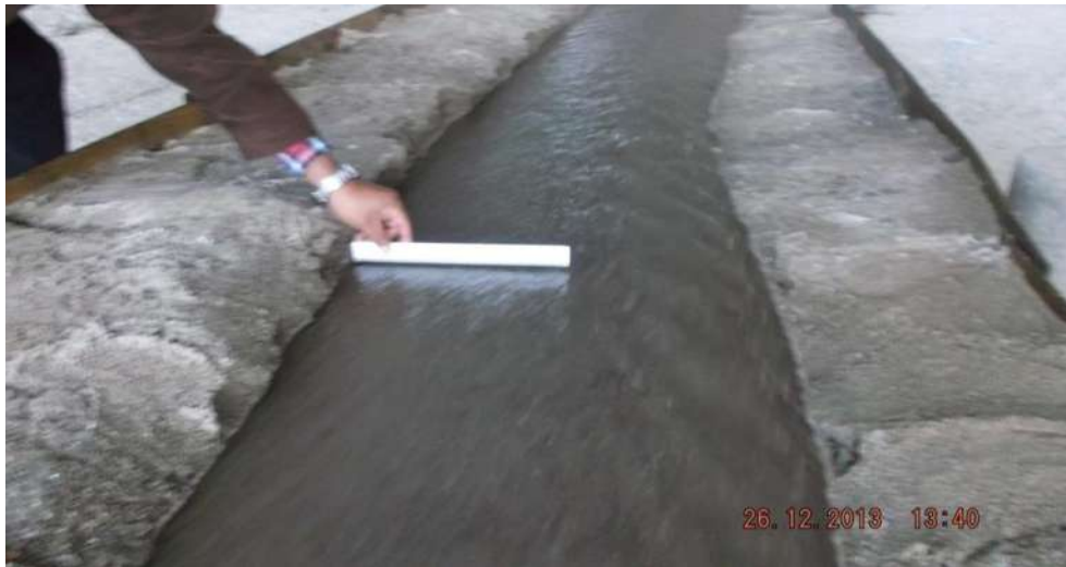
Figura 5.16 Medición de la deformación del bordo.
