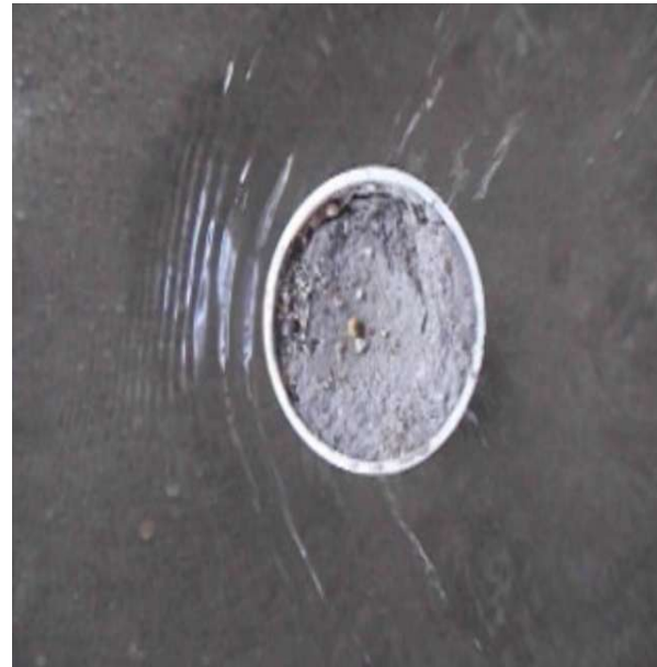
Figura 6.34 En esta prueba el diámetro del foso de socavación que se presenta es de 2.16 cm.
