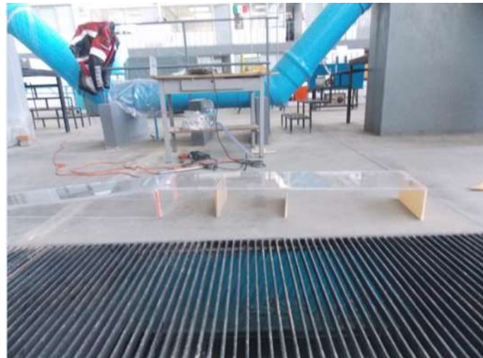
Figura 6.8 Construcción del sostenimiento de la plataforma.
