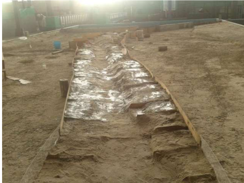
Figura 5.21 Vista panorámica del modelo, con paredes del río estabilizadas.
