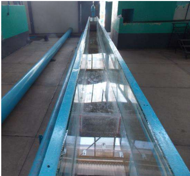
Figura 6.11 Modelo colocado en el canal.
