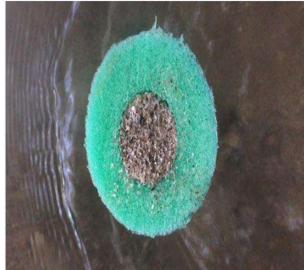
Figura 6.40 En esta prueba el diámetro del foso de socavación es de 3.5 cm
