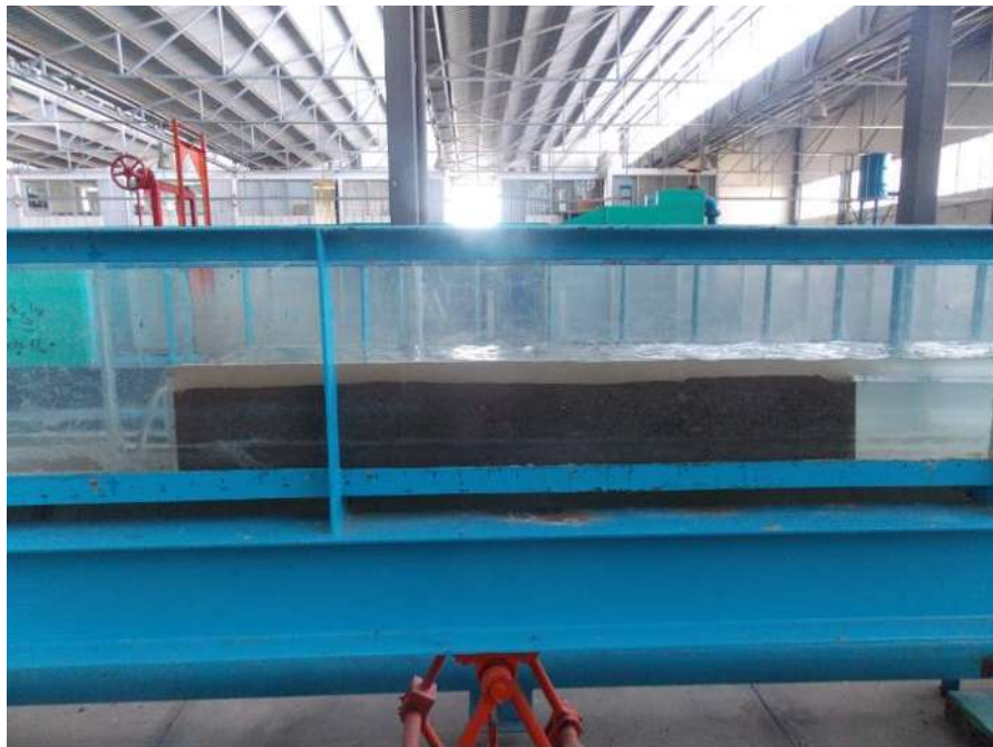
Figura 6.13 Prueba del inicio del movimiento de las partículas.
