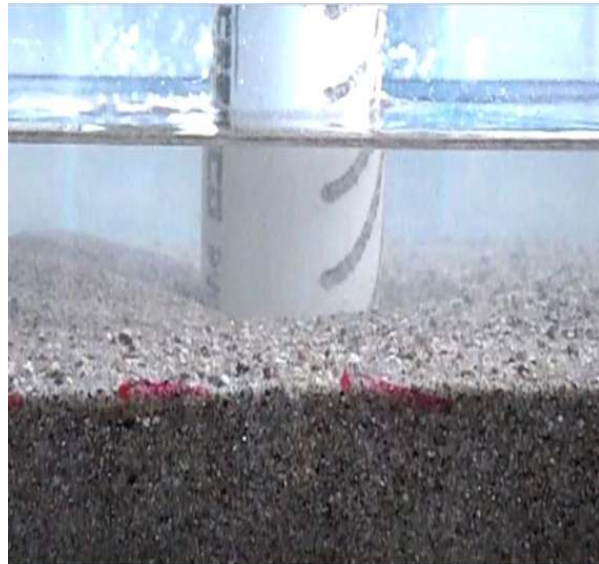
Figura 6.44 En esta prueba el diámetro del foso de socavación casi no se percibe.
