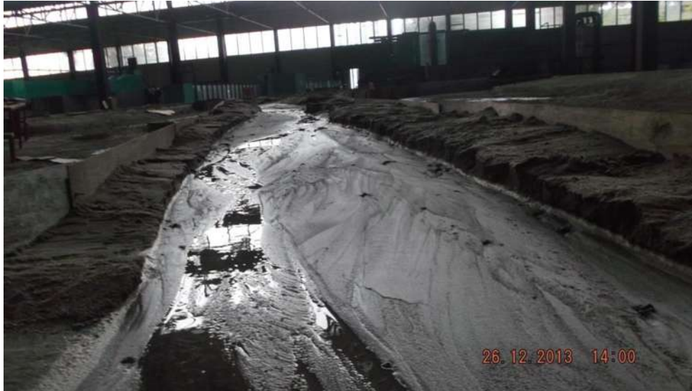
Figura 5.19 Deformación final del flujo, alcanzando un metro de ancho.
