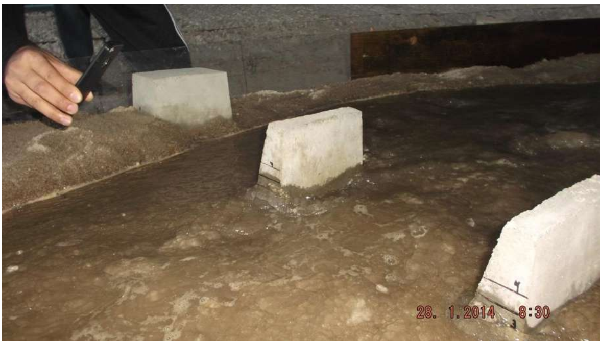
Figura 5.28 Estribo 1 y pila 1 y 2, con flujo circulando entre ellos.
