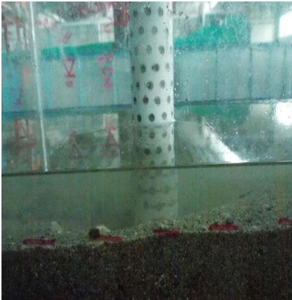
Figura 6.33 En esta prueba el diámetro del foso de socavación que se presenta es de 2.13 cm.
