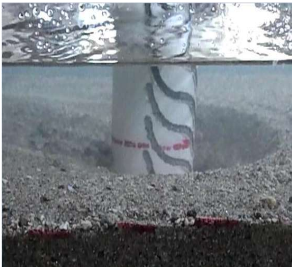
Figura 6.42 En esta prueba el diámetro del foso de socavación es de 1.88 cm.
