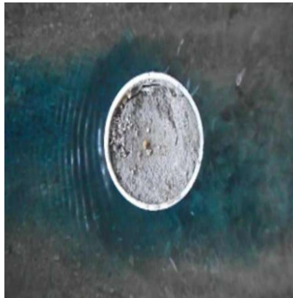
Figura 6.33 En esta prueba el diámetro del foso de socavación que se presenta es de 2.13 cm.
