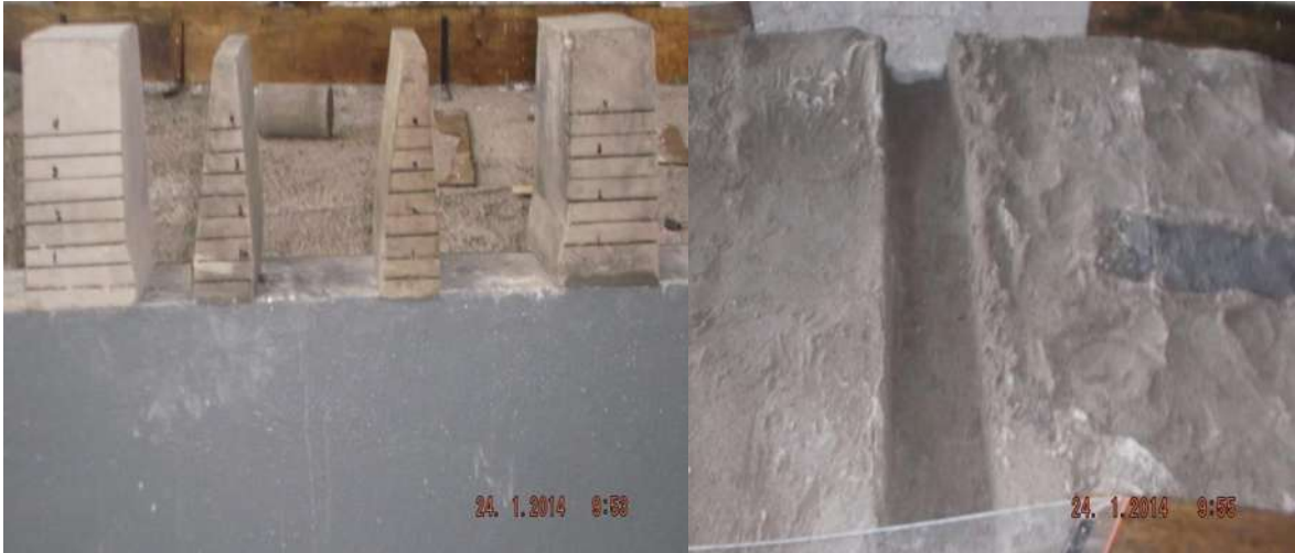
Figura 5.23 a) Pilas y estribos descimbrados y marcados; b) Zanja de excavación para colocar las pilas y estribos.
