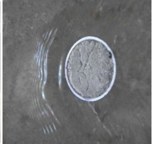
Figura 6.31 En esta prueba el diámetro del foso de socavación que se presenta es de 3.38 cm.
