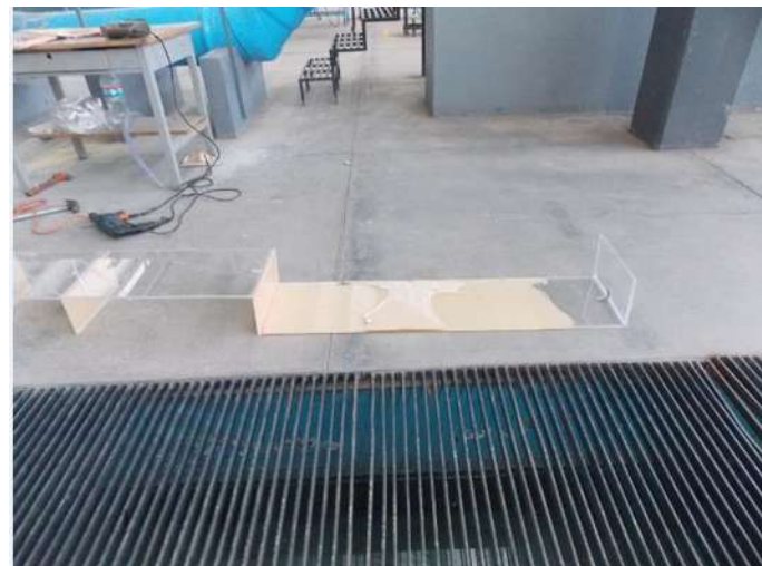
Figura 6.9 Estructura para retener el foso de socavación.
