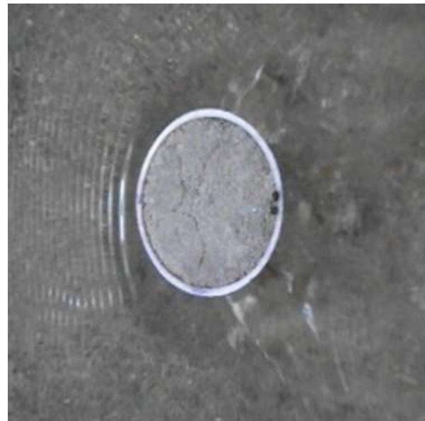
Figura 6.30 En esta prueba el diámetro del foso de socavación que se presenta es de 1.55 cm.
