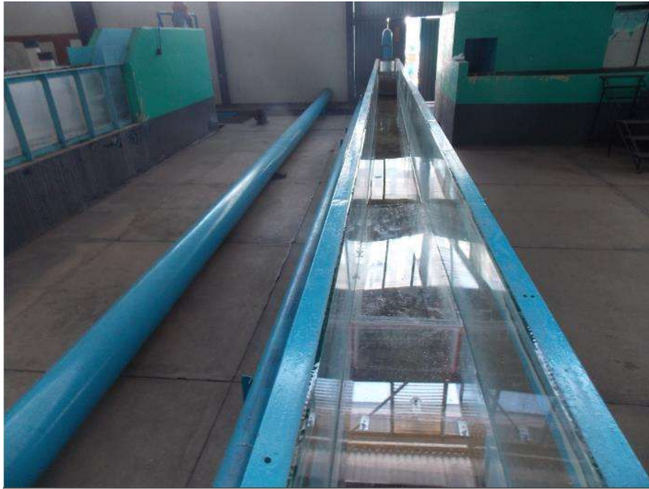
Figura 6.2 Canal de pendiente variable del laboratorio de Hidráulica.
