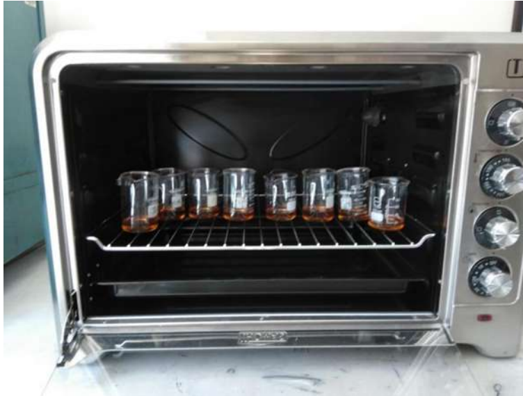
Figura 3.2. Fotografía de las placas sumergidas en el lubricante a 200^{\circ}\text{C} y 1\text{ atm} .
