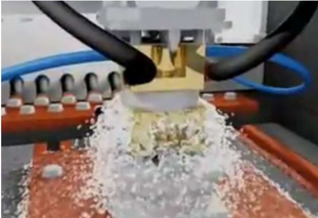
Figura 1 - Flujo de electrolito sobre la pieza de trabajo [3]
