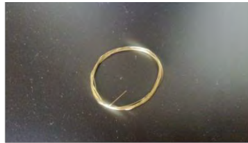
Alambre de latón, fabricado por Celectro, 0.25 mm. de diámetro, 970 N/mm 2
