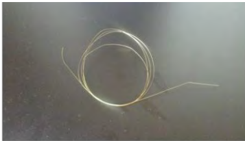
Alambre de latón, fabricado por GF Agie Charmilles Asia, 0.25 mm. de diámetro, 900 N/mm 2
