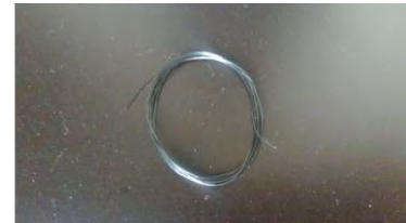
Alambre de molibdeno, fabricado por Changkai Industrial, 0.18 mm. de diámetro.
