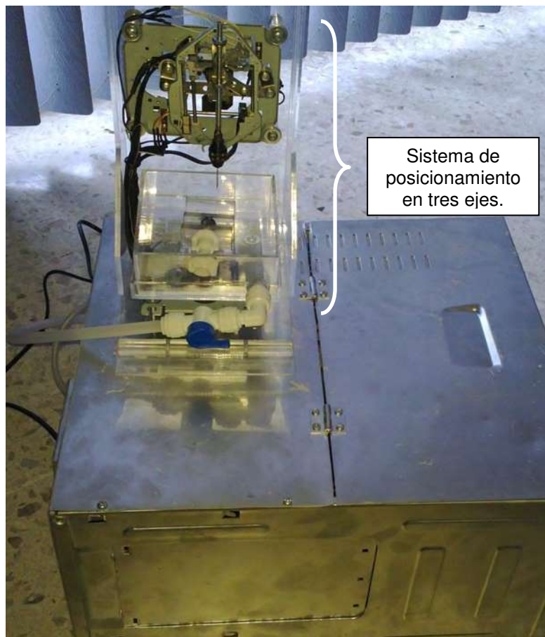
Figura 48 - Sistema de posicionamiento
