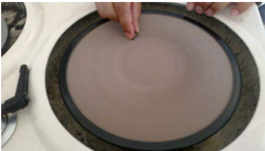
Figura 55 - Proceso de pulido con paño
