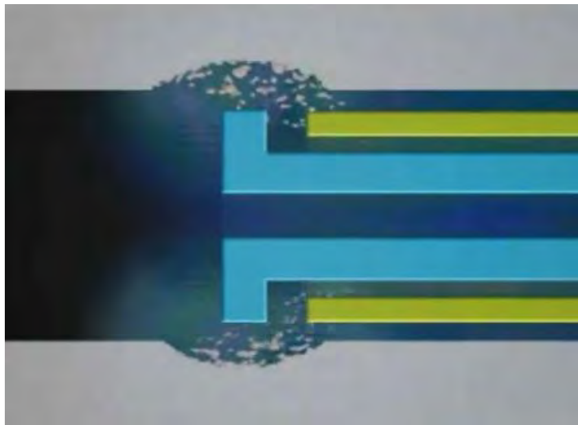
Figura 5 - Desprendimiento de iones de la pieza de trabajo [4]
