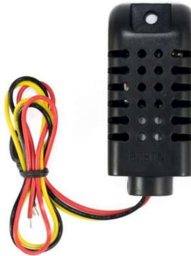
Figura 2. 11.- Sensor DHT21 utilizado para la lectura de la temperatura y humedad.
