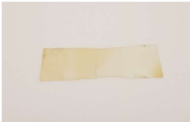
Figura 4. 29.- Probeta de Nafion 115 fracturada (con variación de parámetros ambientales)
