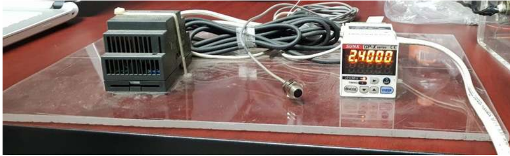
Figura 3. 5.- Sensor de desplazamiento inductivo para calibración de desplazamientos lineales del motor NEMA 23.
