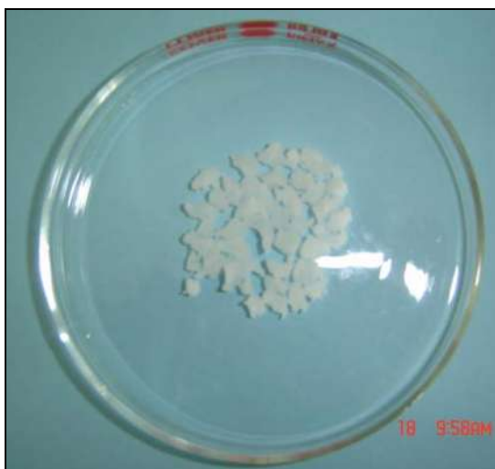
4.19. Típica imagen de las pequeñas fracciones de PSSTOH después del proceso de secado
