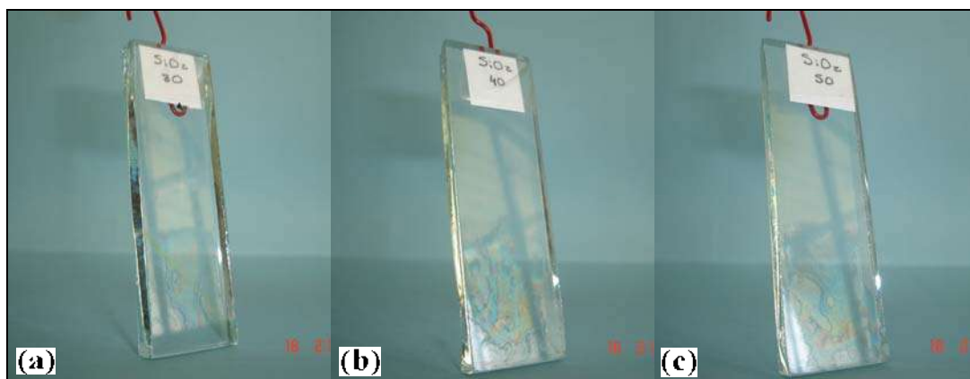
Figura 4.17. Recubrimientos inorgánicos con 100 wt% de \text{SiO}_2 en el proceso de recubrimiento en la fase intermedia: (a) t = 30 min, (b) t = 40 min y (c) t = 50 min
