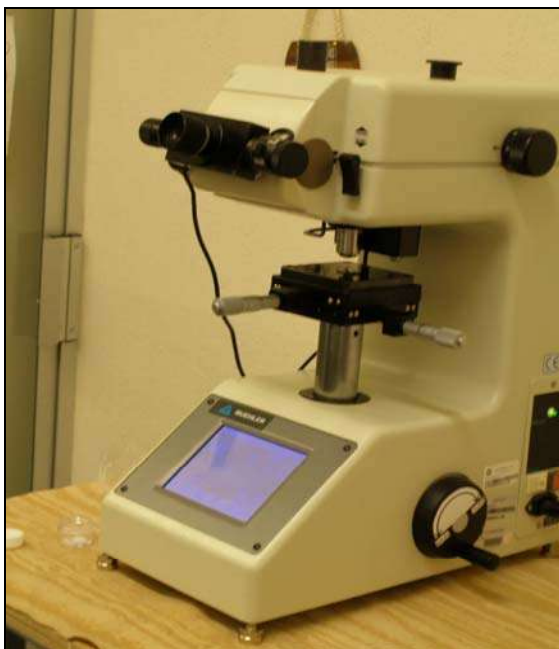
Figura 4.29. Típica imagen del Microindentador Vickers
