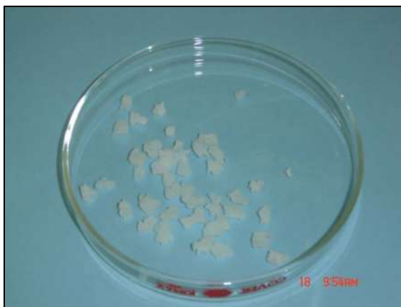
4.4. Típica imagen de las pequeñas fracciones de PSCTOH después del proceso de secado
