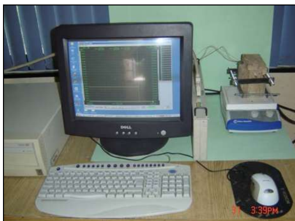
Figura 4.37. Típica imagen del arreglo experimental del método del Disco de Lee
