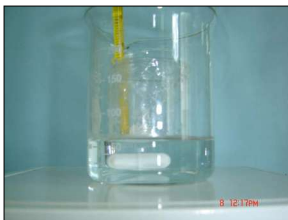
Figura 4.12. Adición de la solución 2 (H 2 O/HF/HNO 3 ) a la solución 1 para dar origen a la solución inorgánica.
