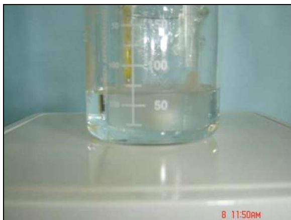
Figura 4.13. Adición de la solución 3 (PSCTOH/THF/DTDLD) a la solución 1 y 2 para dar origen a la solución híbrida.
