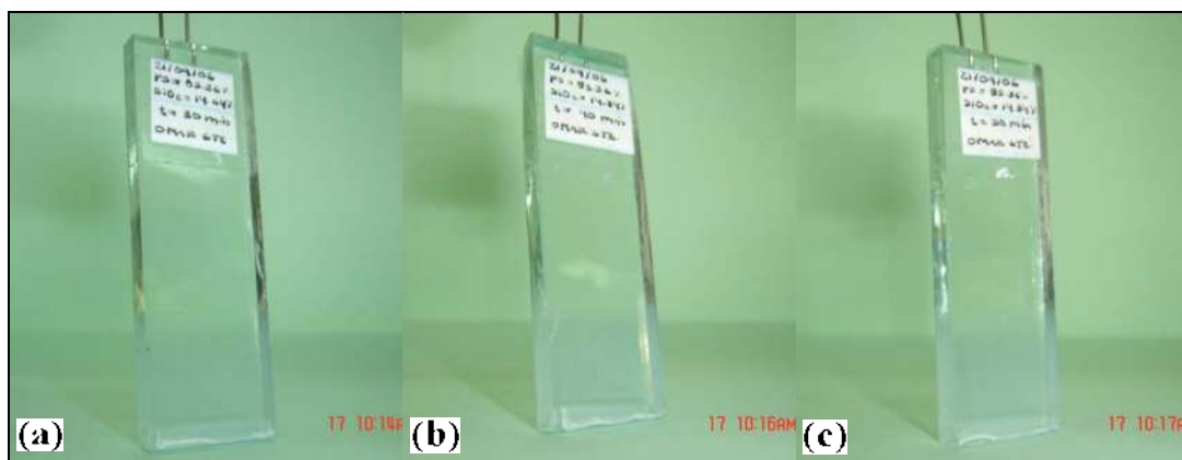
Figura 4.15. Recubrimientos híbridos con 14.64 wt% de \text{SiO}_2 y 85.36 wt% de PS en el proceso de recubrimiento en la fase intermedia: (a) t = 30 min, (b) t = 40 min y (c) t = 50 min
