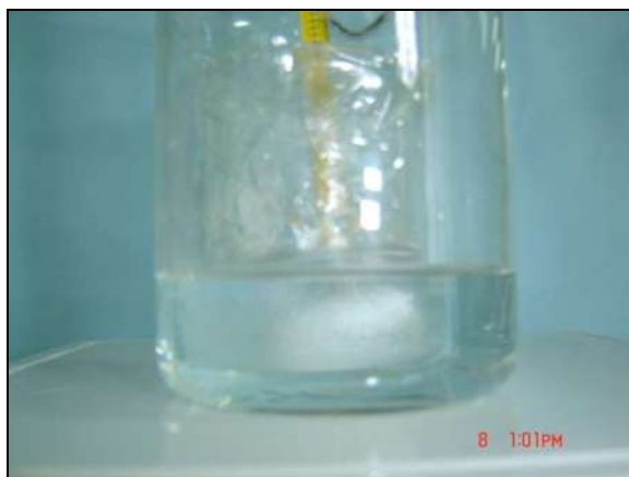
Figura 4.11. Adición de los reactivos que conforman la solución 1 (TEOS/EtOH/H 2 O).
