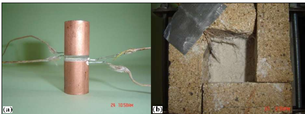
Figura 4.36. (a) Típica imagen del sistema: MSiO 2 sin PS adsorbido superficialmente y (b) Cámara de aislamiento del sistema en la medición de la temperatura en función del tiempo
