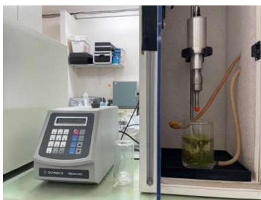
Figura 11. Mezcla de polvo de P. guajava Cv Hidrozac y agua destilada en ultrasonificador VCX 500, para extracción de compuestos bioactivos.
