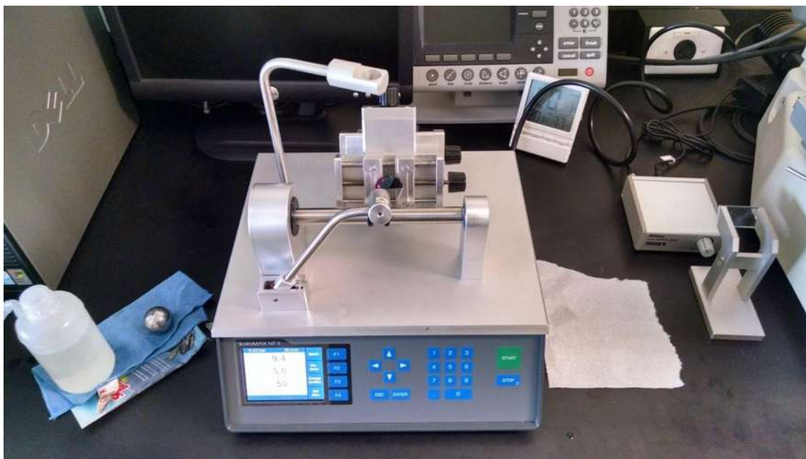
Fig. 3.11. Equipo Kalomax NT II, donde se coloca la muestra para ser atacada con la esfera y generar la calota.
