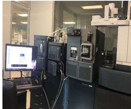
Figura 7. A). Extractos metanólico, acetónicos y acuosos. B). UPLC; (Waters Corp., Milford, MA, EUA) _acoplado a un espectrómetro de masas triple cuadrupolo Xevo TQ-S (Waters Corp., EE.UU)
